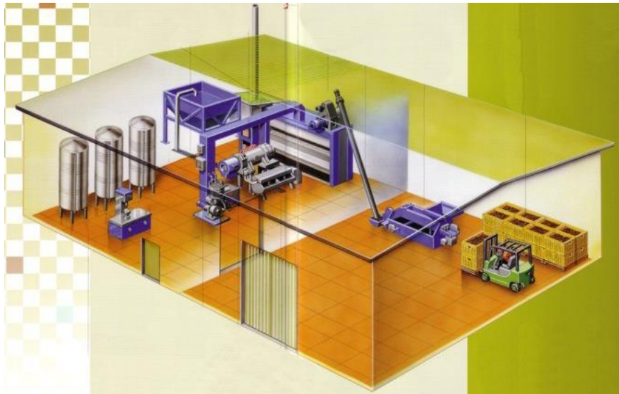
Figura 3. Distribución en planta del proceso productivo de elaboración de aceite de oliva.
