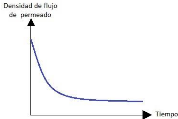
Figura 10. Disminución de la densidad de flujo de permeado con el tiempo.
