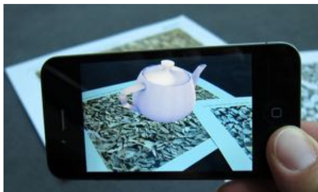
Imagen 38: Aplicación de demostración de Vuforia visualizando una tetera sobre las imágenes objetivo. © Qualcomm Connected Experiences, Inc. [Fuente: https://developer.vuforia.com/library/articles/Solution/Compiling-and-Running-a-Vuforia-iOS-Sample-App ]
