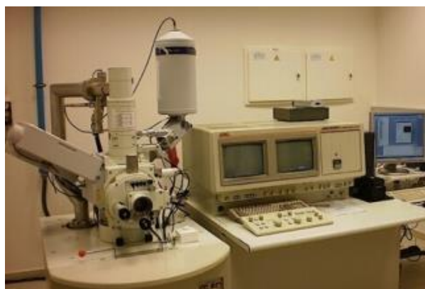
Imagen XXVII. Imagen de un microscopio electrónico de barrido modelo JEOL JSM6300. Imagen tomada del servicio de microscopía electrónica de la Universitat Politècnica de València.
