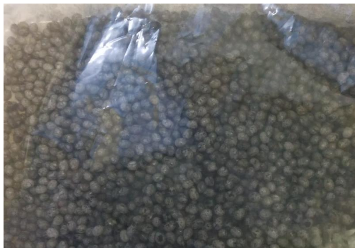
Imagen XI. Polímero y catalizador ya mezclado, (1% de fracción másica de catalizador).Preparado por Santiago Ferrandiz Bou, departamento de mecánica y materiales, Alcoi.
