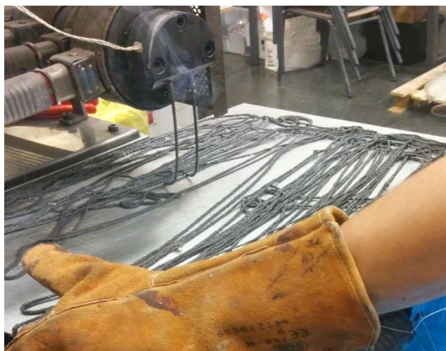
Imagen XII. Cabezal de la extrusora de doble usillo extrusionando el nuevo material.
