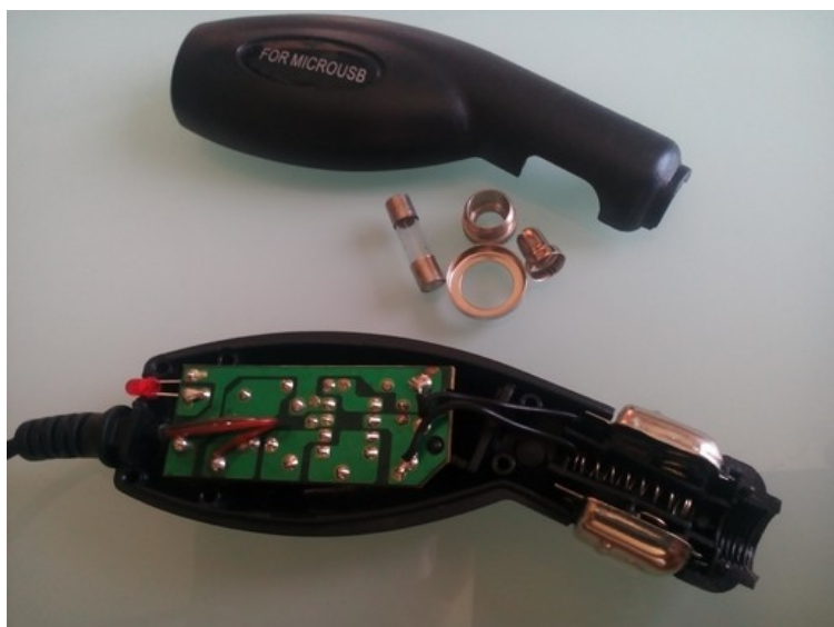
Ilustración 17: Cargador de coche desmontado
