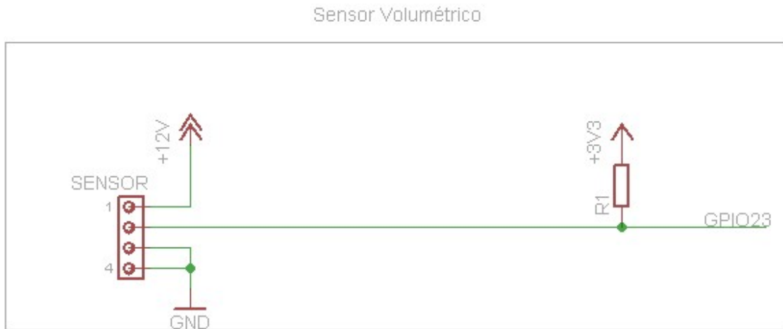
Ilustración 33: Esquema eléctrico conexión sensor volumétrico
