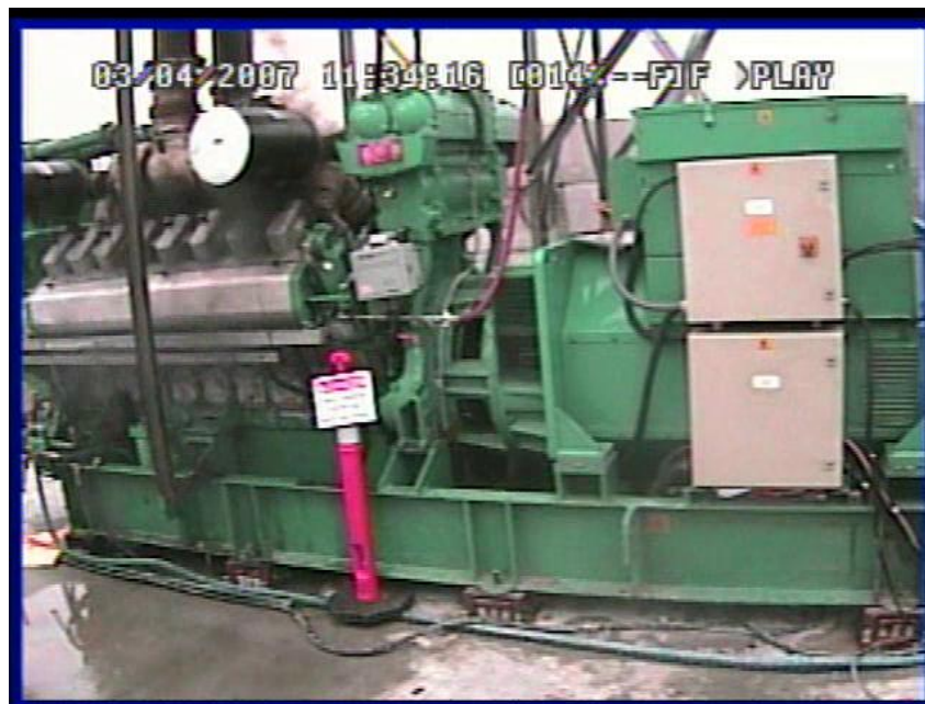
Figura 16: El generador diesel utilizado en el experimento Aurora humeando y sacudiéndose al salir de régimen. (Fuente: Wikipedia. https://en.wikipedia.org/wiki/Aurora_Generator_Test (Último acceso 17/09/2015))
