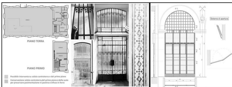
Figura 3. A destra_ Planimetria di metaprogetto e caratteri figurativi loc.3 A sinistra_ Mercato di Mezzo a Bologna: miglioramento energetico dell'infisso
