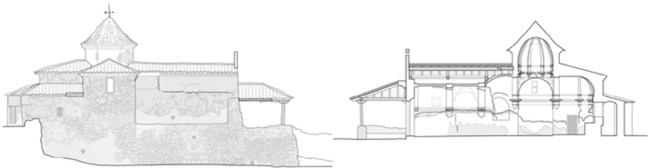
Figura 5. Ejemplos de mapeados de patologías. Alzado Oeste y Sección longitudinal. Fuente propia
