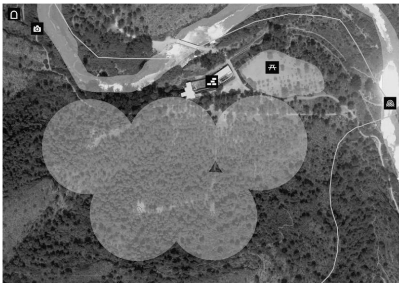
Figura 4. Disposición de cañones de agua
