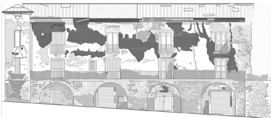
Figura 4. Rilievo delle patologie del prospetto sud
