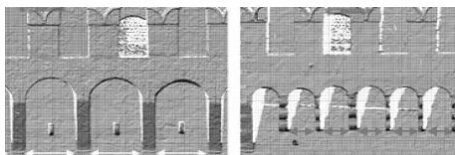
Figura 5. Facciata su Piazza Nettuno. Beccatelli a confronto nel rilievo con il laser-scanner.
