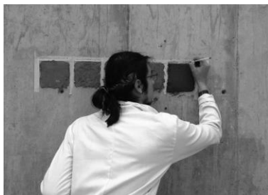
Figura 2. Aplicación de enjarres de diferentes tipos. UAM-Xochimilco, México. (L. Guerrero, 2015)
