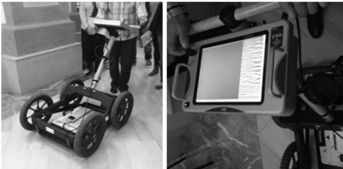
Figura 2. Investigación del subsuelo del Monasterio de los Jerónimos, Guadalupe (Murcia) (izquierda). Radargrama obtenido (derecha). (Fuente: Los autores)
