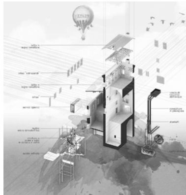
Figura 3. Spaccato assonometrico di progetto della Torre Museo dell'Acqua, con la riproposizione dell'originario marchingegno per il sollevamento dell'acqua.
