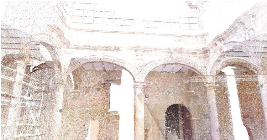
Fig. 10- Nube de puntos general del patio central a través del escáner laser 3D.
