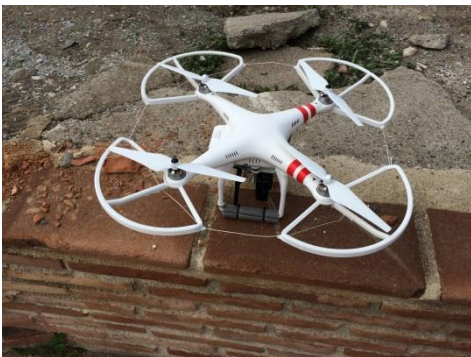
Fig. 2- Cuadricóptero con cámara adaptada para la toma de fotografías.
