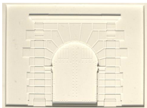
Fig. 8- Fresado de puerta con control numérico.
