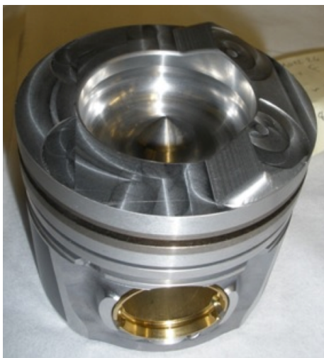
Figura 3.7a: Geometría característica del pistón
