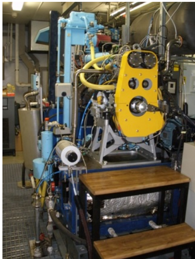
Figura 3.6: Motor monocilíndrico de investigación
