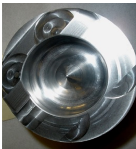
Figura 3.7b: Geometría característica del pistón
