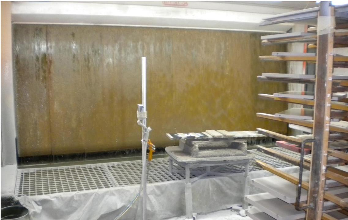
IMAGEN 6.16: FOTOGRAFÍA DE LA CABINA DE PULIMENTADO
