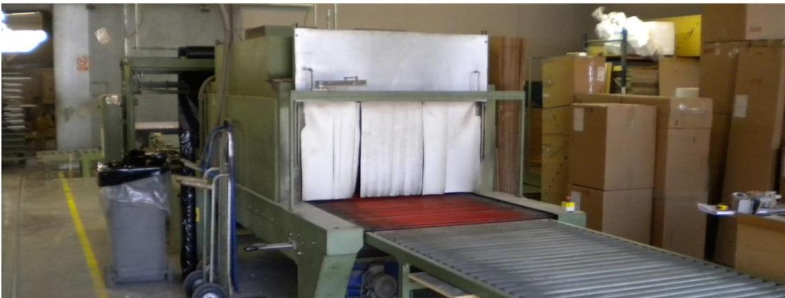
IMAGEN 6.18: FOTOGRAFÍA DE MÁQUINA EMBALADORA REAL DE LA FÁBRICA
