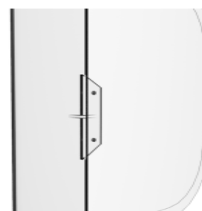
Figura 21. Detalle nervio soporte para el cierre magnético.
