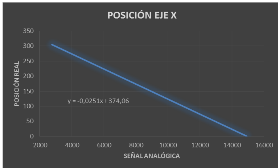
Figura 6.13 Recta de conversión señal analógica a posición real eje x
