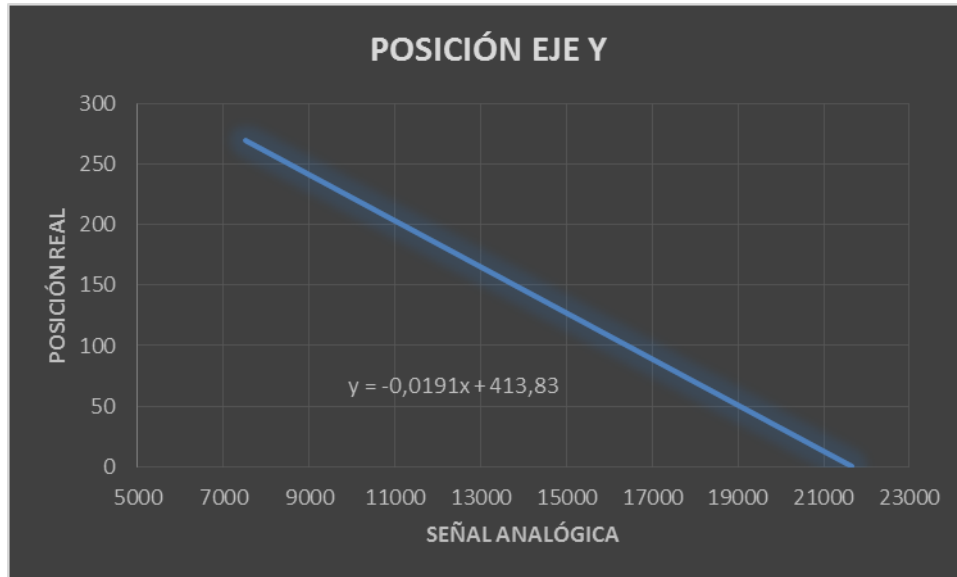
Figura 6.14 Recta de conversión señal analógica a posición real eje y
