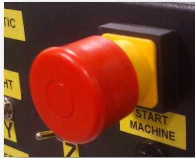
Figura 1.9 Pulsador de emergencia
