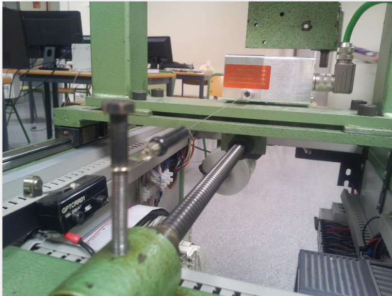
Figura 1.6 Potenciómetro utilizado para controlar la posición en el eje x
