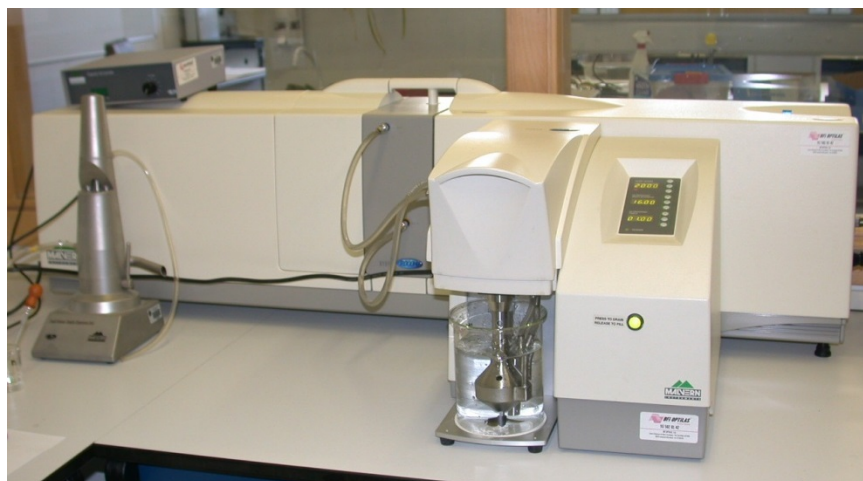
Figura 4.1 Difractómetro láser Malvern Instruments (Instituto de tecnología de Materiales UPV)
