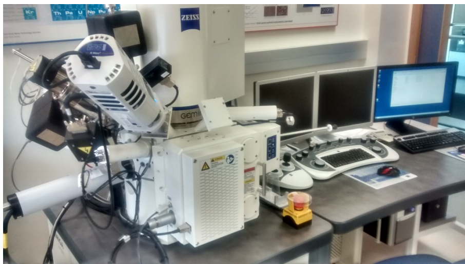
Figura 4.13 Microscopio electrónico de barrido de emisión de campo con cañón de iones de Galio, ubicado en el servicio de microscopía de la UPV
