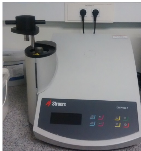
Figura 4.9 Embutidora automática de muestras ubicada en el Instituto de tecnología de materiales (ITM) de la UPV
