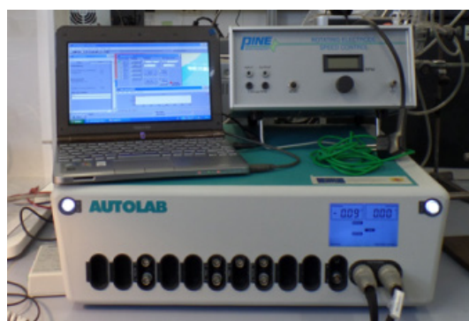
Figura 4.25. Potenciostato, ubicado en Ingeniería Química de la UPV
