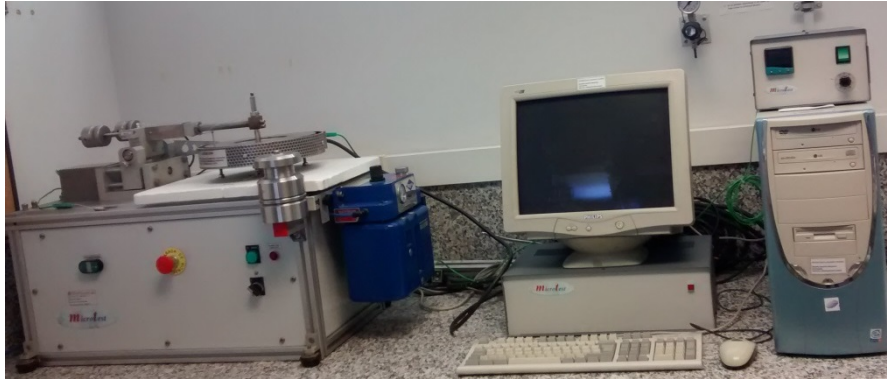
Figura 4.18 Montaje del ensayo en tribómetro en configuración bola sobre disco, equipo perteneciente al Instituto de tecnología de materiales (ITM) de la UPV
