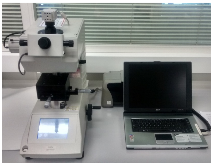
Figura 4.14 Microdurómetro Vickers ubicado en el Instituto de tecnología de materiales (ITM) de la UPV
