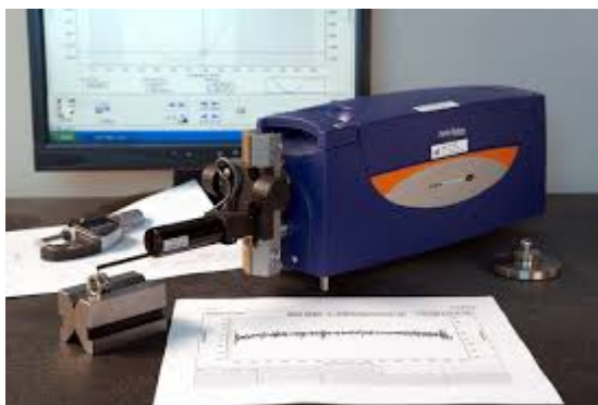
Figura 4.20 Perfilómetro inductivo de contacto, ubicado en el Instituto de Desarrollo Regional de la Universidad de Castilla-La Mancha, Albacete, España
