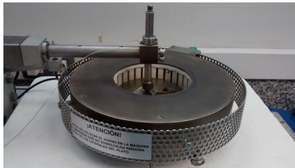
Figura 4.19 Horno eléctrico para el calentamiento de la muestra durante el ensayo
