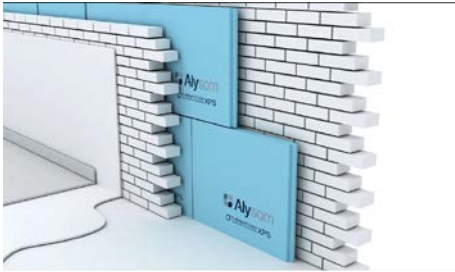
Imagen 12. XPS como aislante en un cerramiento.
