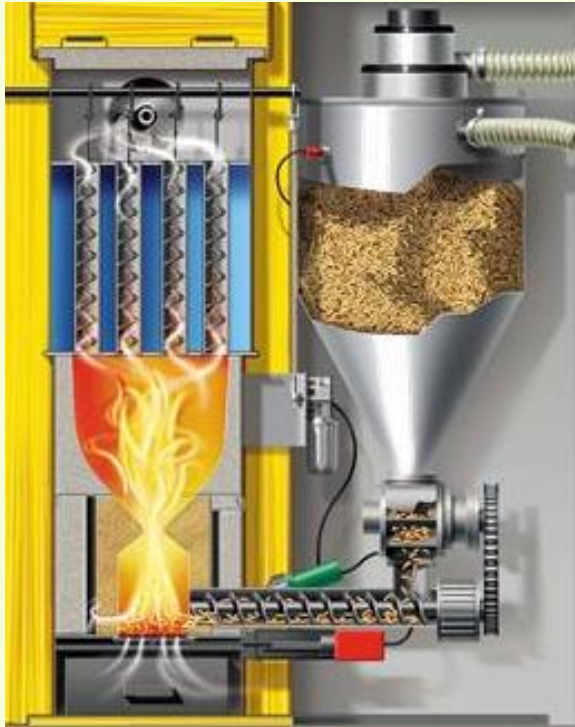
Imagen 38. Caldera de biomasa.
