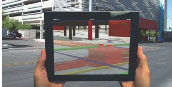
Ilustración 20: Realidad aumentada en el trazado de instalaciones en vial. (Building desing construction, s.f.)
