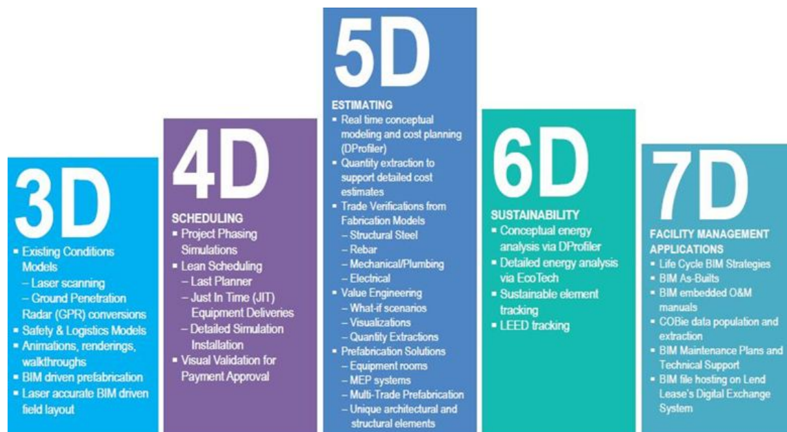
Ilustración 13: Dimensiones BIM (Building Smart, 2013)
