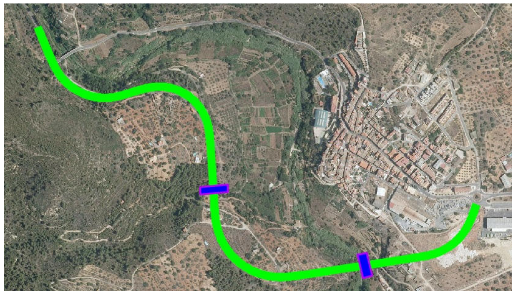
Fig. 68. Zonas de paso de fauna bajo estructuras. (Fuente: Luis Romero)
