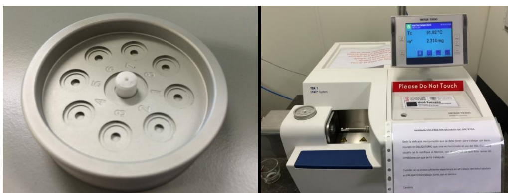
Figura 3.7. Análisis termogravimétrico. Izquierda: crisol que contiene la muestra; derecha: TGA
