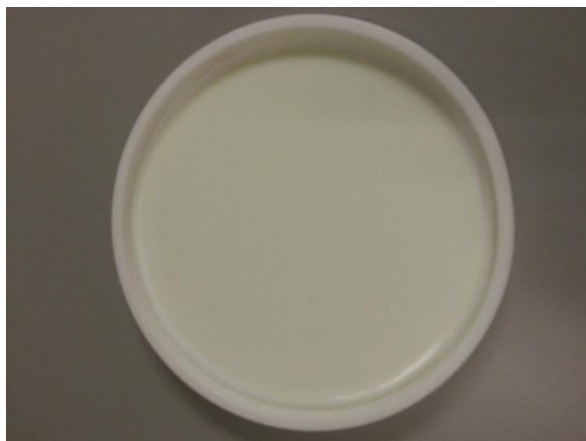
Figura 3.1. Placa de teflón utilizada para la formación de las películas.
