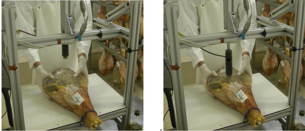
FIGURA 3. Brazo deslizante en posición inicial (izquierda) y en contacto con el alimento (derecha).
