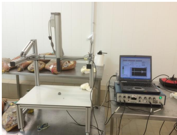
FIGURA 2. Sistema automático de caracterización ultrasónica de alimentos.
