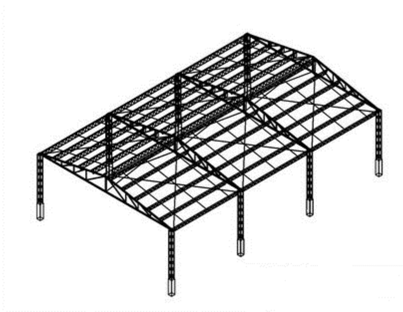
Figura 14 : Estructura con cercha tipo Pratt y correas
