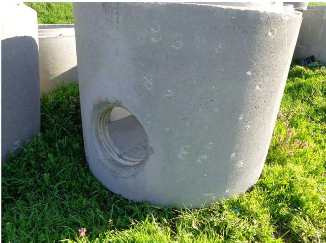
Los materiales utilizados en obra se acopiaban cuando era posible directamente en obra, tubería de PAFSIN, pozos prefabricados de hormigón, pozos de plástico para las conexiones a las propiedades, tapas de material plástico resistente al tráfico pesado.
