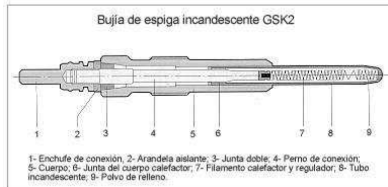
Figura 2.8 Bujía de espiga incandescente.
