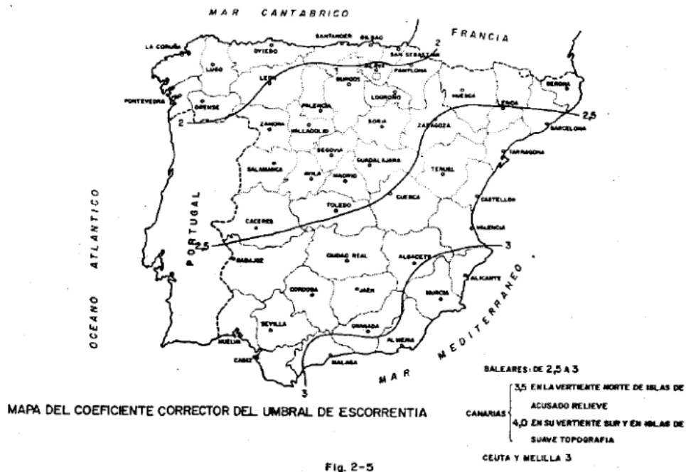
Figura 1.- Mapa del coeficiente corrector del umbral de escorrentía. (Figura 2-5 de la Instrucción 5.2-IC, MOPU, 1990).
