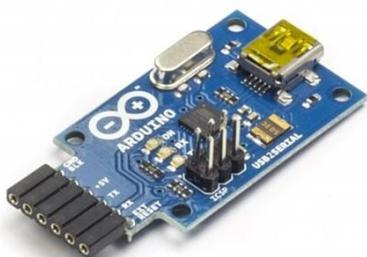
Esta placa convierte la conexión USB en los 5 voltios TX y RX que se pueden conectar directamente a la
