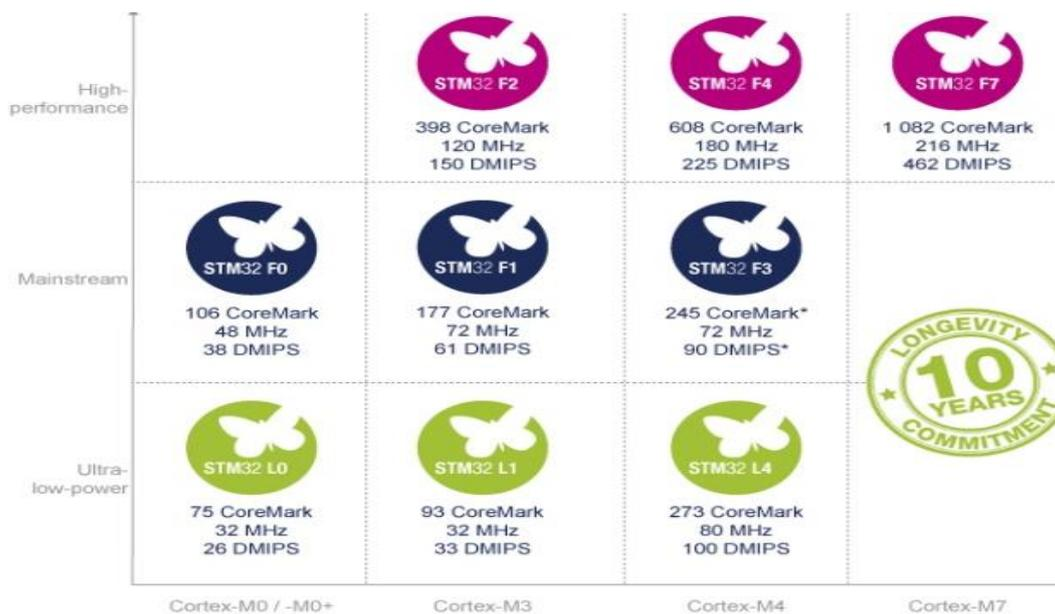
La familia STM32 se compone de siete series de microcontroladores: F4, F3, F2, F1, F0, L4, L1, L0, W. Cada serie de microcontroladores STM32 se basa en un procesador de ARM Cortex-M4F, Cortex-M3, Cortex-M0 + o Cortex-M0. El Cortex-M4F es conceptualmente un Cortex-M3 al que se añade DSP e instrucciones de precisión simple y coma flotante.
