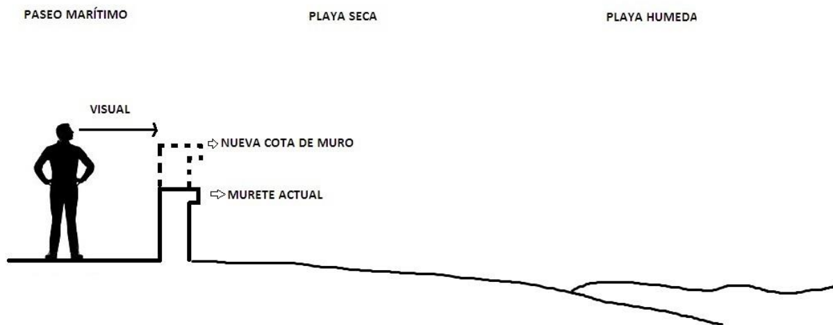
Figura 1. Nueva cota de muro
