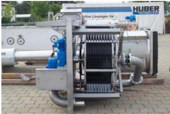
**Imagen 6.-** Membrana para Reactor MBR.
