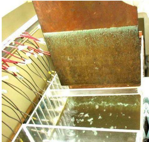
**Imagen 18.-** Cátodo para precipitación electroquímica.
