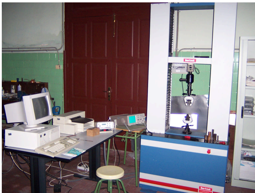
Figura 1.6. Máquina universal de ensayo Ibertest Elib 50/W.
