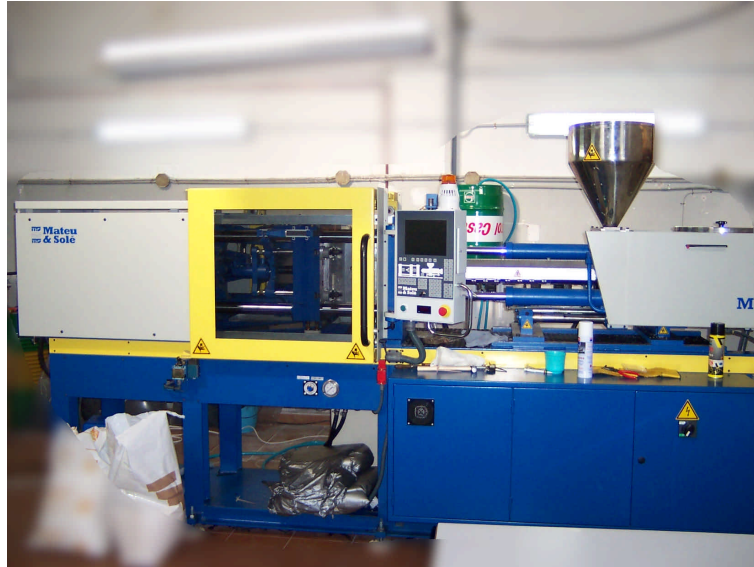
Figura 1.4. Inyectora Matéu & Solé Meteor 270/75.
