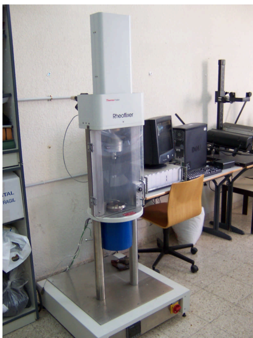
Figura 1.3. Reómetro capilar Rheoflizer MT.
