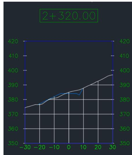
Fig. 5 Terreno en media ladera en roca. Fuente: Elaboración propia en AutoCAD Civil 3D.
