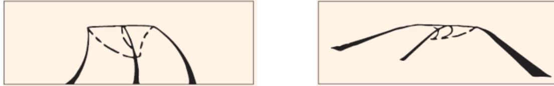
Figura 9. Condición de acuerdo convexo coincidente con punto de inflexión. Fuente: Norma 3.1-IC.
