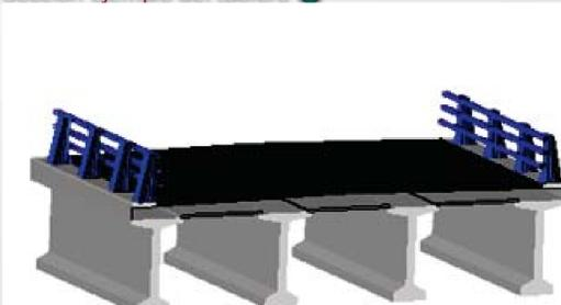
Vigas prefabricadas doble T + prelasas
