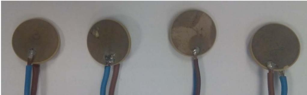
Fig. 12. Muestra de las cerámicas disco soldadas a los cables para medición
