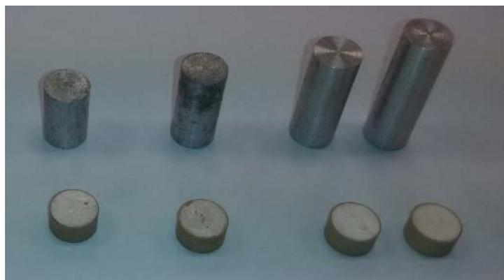
Fig. 6. *Ejemplo de capas de adaptación para los piezoelectricos*
