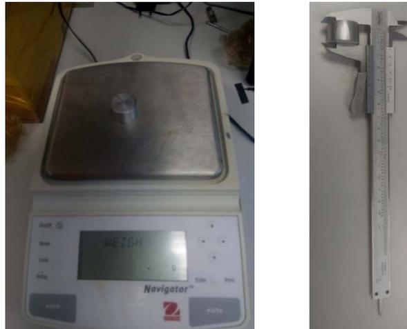
Fig. 22. Balanza electrónica y pie de rey utilizados en las mediciones
