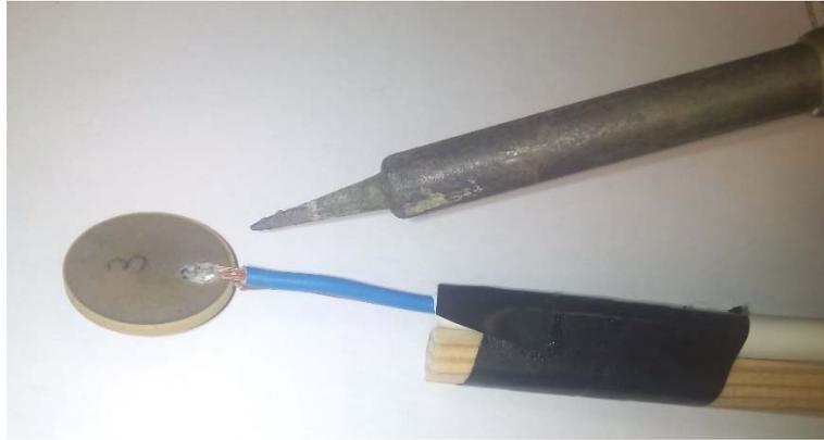
Fig. 11. Ejemplo soldadura para alimentar la cerámica
