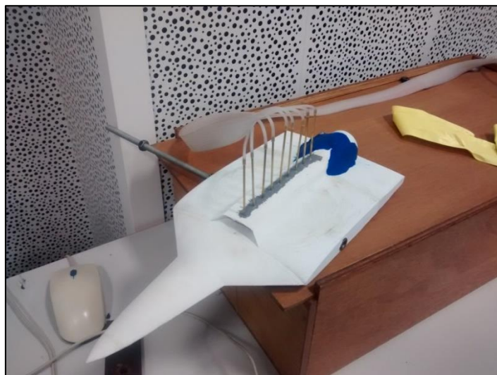
Figura 82 – Montajes sondas de presión
