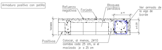
Detalle de borde extremo. Forjado reticular. Bloques perdidos.
