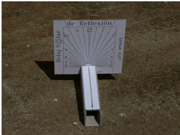
Figura 33 - Reloj Solar por reflexión (Capriles H, 2012)
