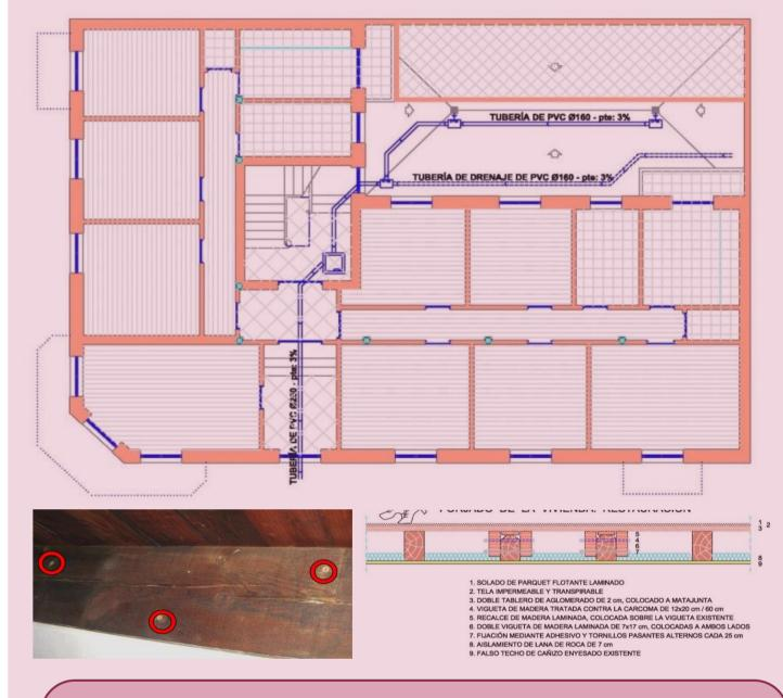
La eliminación de las humedades y la consolidación de la madera, da al edificio la solidez y durabilidad que los propietarios desean para poder seguir disfrutando de la vivienda, durante 50 años. La intervención en el forjado nos permite mejorar el aislamiento térmico y acústico de la viviendas.
