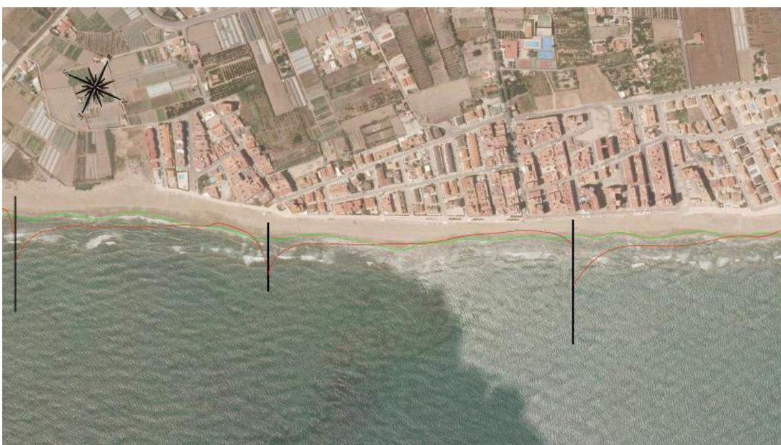
Figura 10 – Alternativa 1: Defensas transversales y alimentación artificial
