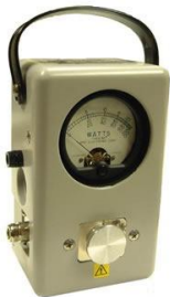
Fig. 8: medidor BIRD 43 , fabricado por Bird Technologies, es un instrumento de altísima precisión usado en laboratorios. Su rango de frecuencias y potencias se varía mediante unos insertos tubulares en el medidor diseñados estos para unos rangos de frecuencia y de potencias determinados.
