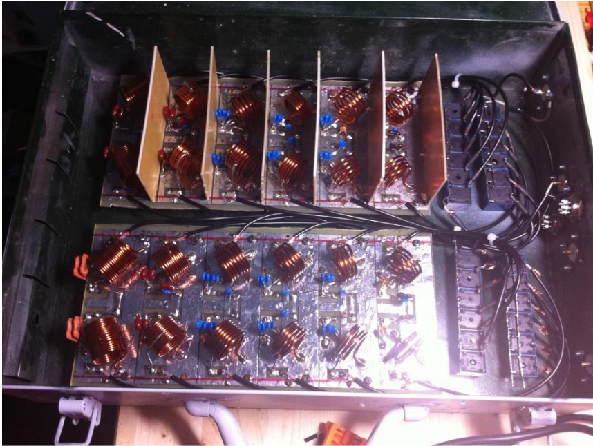
Fig. 45: Vista general de los filtros con los relés de conmutación dentro de la caja metálica.
