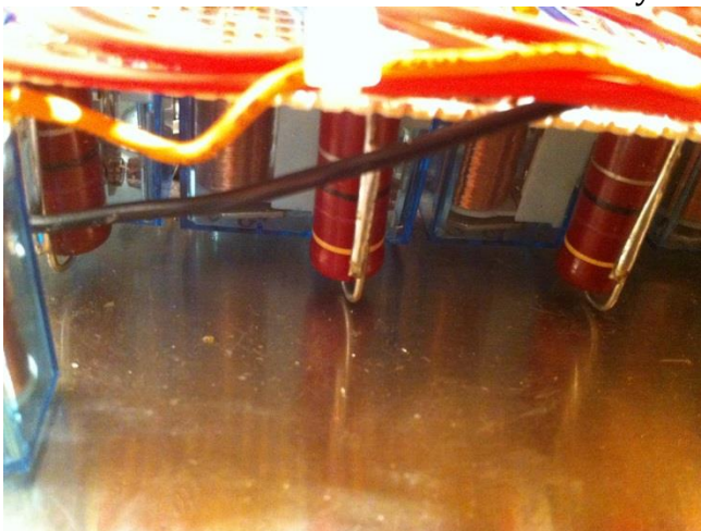
Fig. 41: Placa de topes de baquelita con los relés y las resistencias ya montadas. Las resistencias terminales son de 510 \Omega y 5W de potencia.
