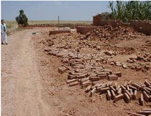
Fabricación de ladrillo tradicional en la región de Safi, Marruecos.
