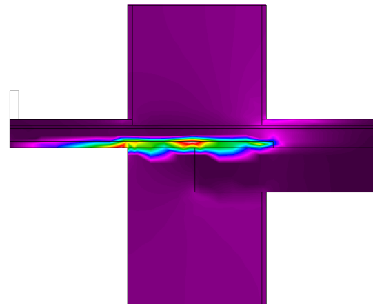
Figura 45. Fachada-Forjado (balcón). Flujo de energía.
