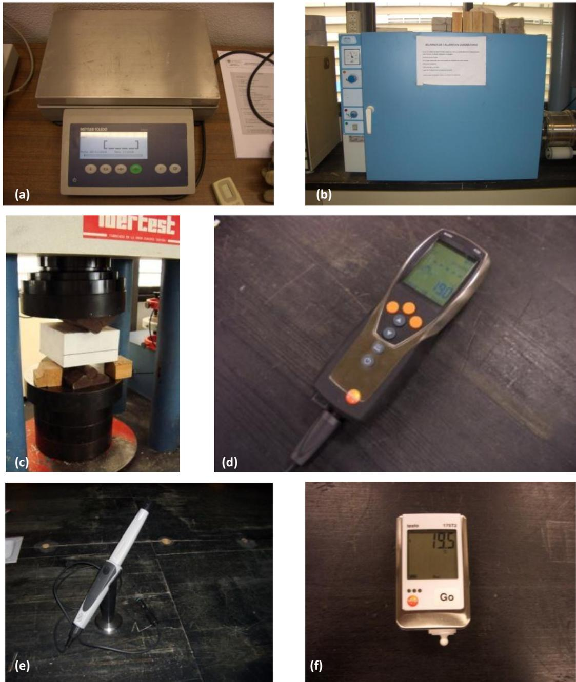
Figura 3.8. (a) Balanza de precisión Mettler Toledo. (b) Estufa de secado "Conterm". (c) Máquina de ensayo para materiales de alta resistencia a la compresión. (d) Medidor de climatización multifuncional Testo 435. (e) Sonda IAQ. (f) Registrador de datos de temperatura Testo 175 T2
