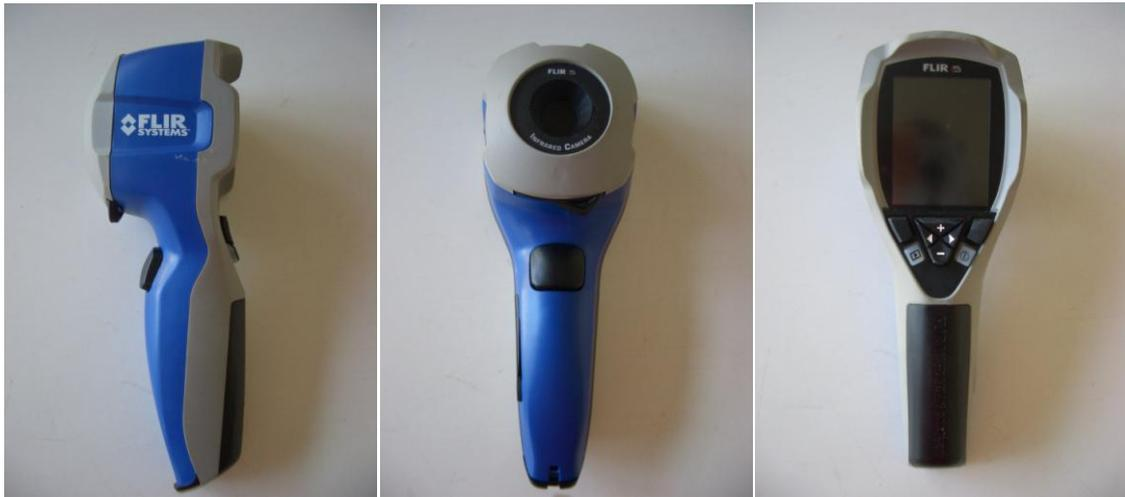
Figura 3.6. Detalle de la cámara de infrarrojos i5
