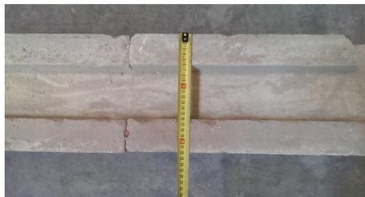
Ancho admisible del marco de ensayo Normalizado.
