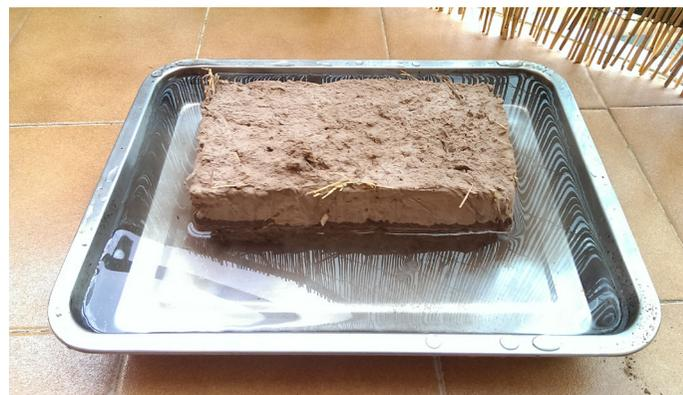
Ensayo a capilaridad de la muestra de adobe procedente de Bétera
