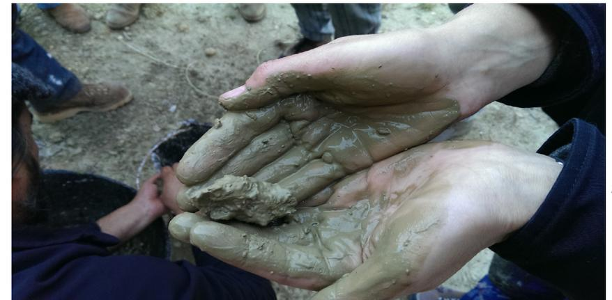
Ensayo previo de campo de una muestra de tierra.
