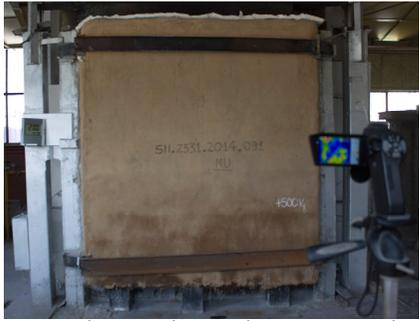
Ensayo de muro de paja de 40cm revestido con revoco de barro de 2 cm en cada cara. Santiago de Chile.
