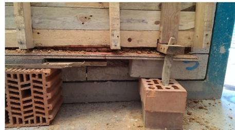
Ajuste del tapial en el marco Normalizado para el ensayo de resistencia al fuego en AIDICO. Se comprueba que el espesor de 50cm no es posible emplearlo. No existen en las instalaciones otro marco apropiado que se ajuste a este ensayo.
