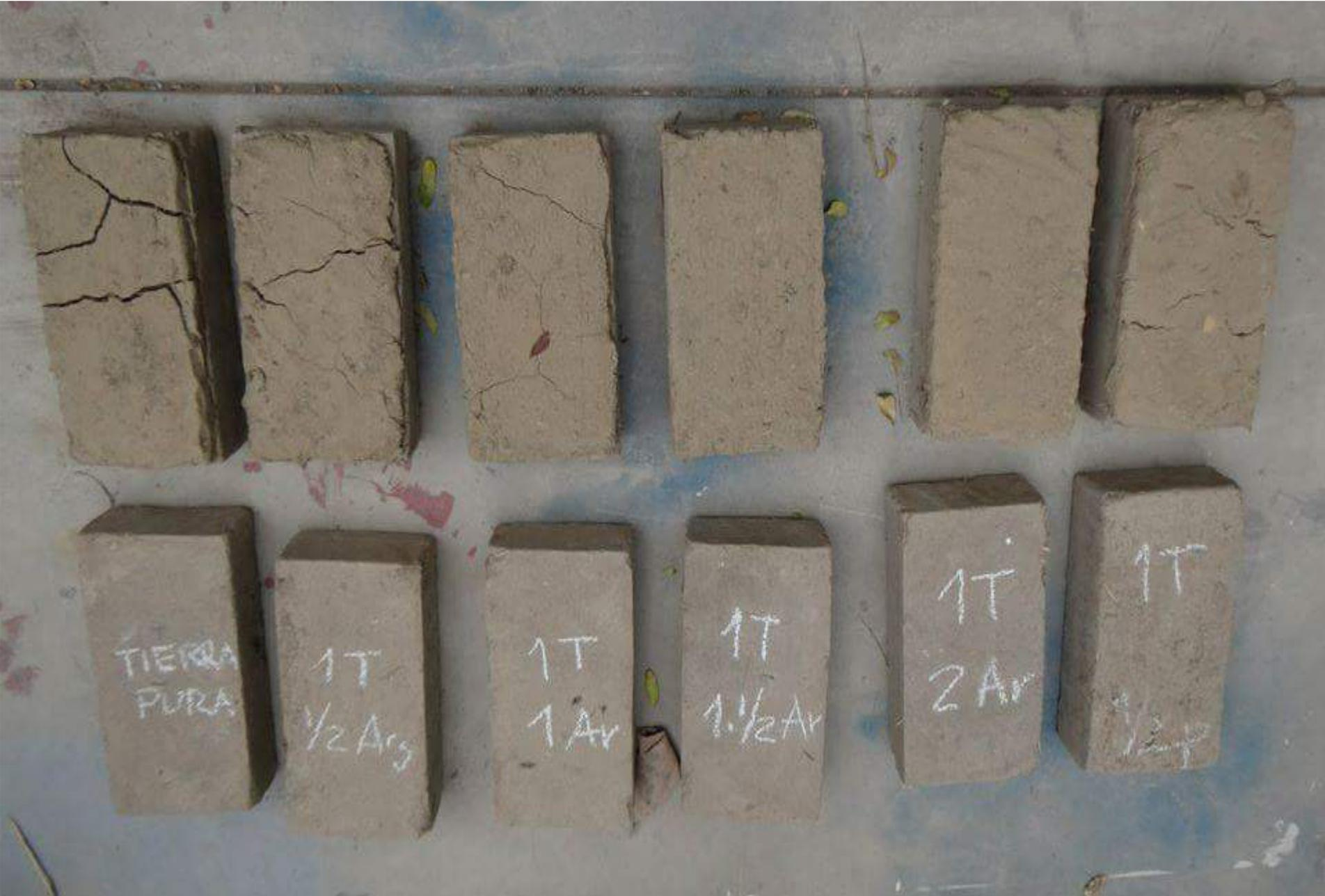
Ensayos de dosificación a ladrillos de adobe. Una mayor proporción de arcilla origina grietas, mientras que un exceso de arena le resta resistencia.
