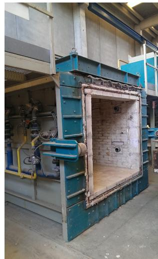
Horno Normalizado para el ensayo de resistencia a fuego en AIDICO. Fuente. propia.
