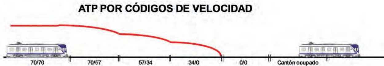
Figura 2.3. ATP con códigos de velocidad. Fuente. Melis et al. (2008).
