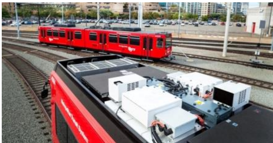
Figura 3.12. Baterías en techo de vehículo. Fuente: Siemens.
