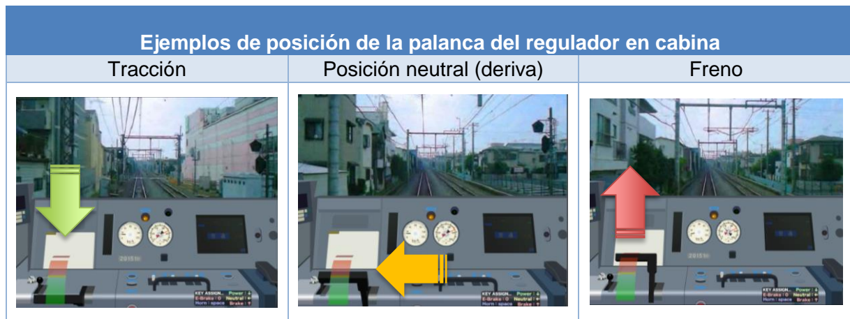
Figura 6.6. Imágenes de posición de la palanca del regulador. Fuente: http://todotrenesarg.com.ar/
