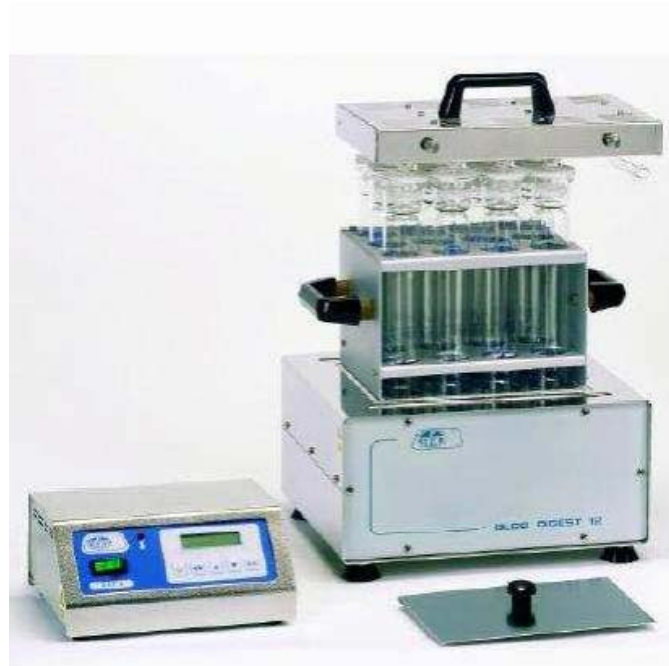
Figura 13. Equipo digestor completo compuesto por Bloque metálico conectado a programador de procesos tiempo/temperatura, gradilla portatubos con tubos de digestión y colector de humos.
