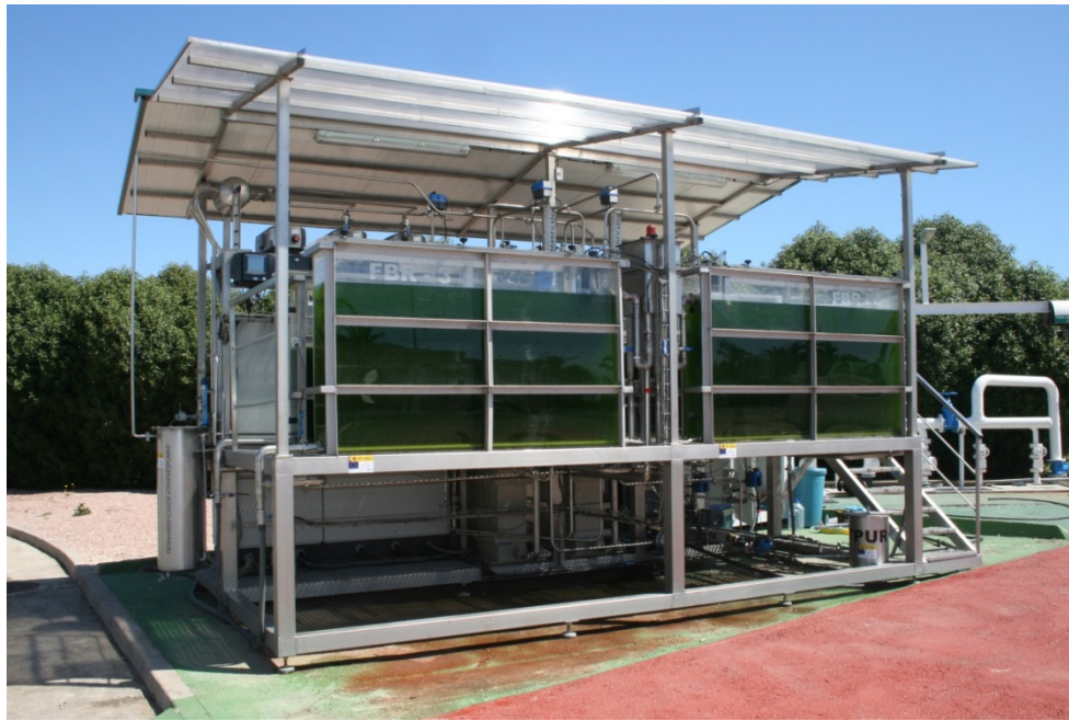
Figura 5. Planta piloto ubicada en la EDAR de la Cuenca del Carraixet
