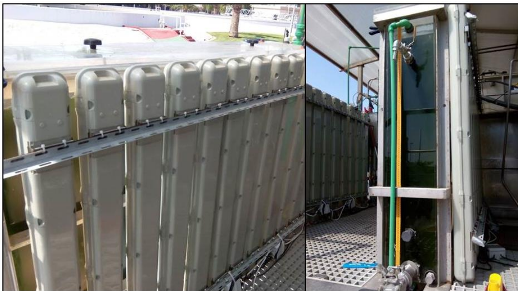
Figura 20. Detalle de las lámparas del sistema de iluminación artificial y de la cinta métrica para el cálculo de volumen
