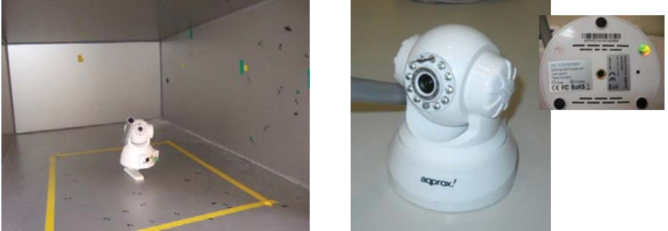
Figura 3.5. Cámaras controladas por IP e instalación de una de ellas en el interior de la cámara de transmisión de tamaño reducido.
