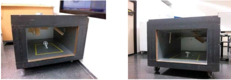
Figura 3.10. Paneles difusores de contrachapado de madera colocados en el interior del recinto emisor (derecha) y receptor (izquierda) de la cámara de transmisión de tamaño reducido.
