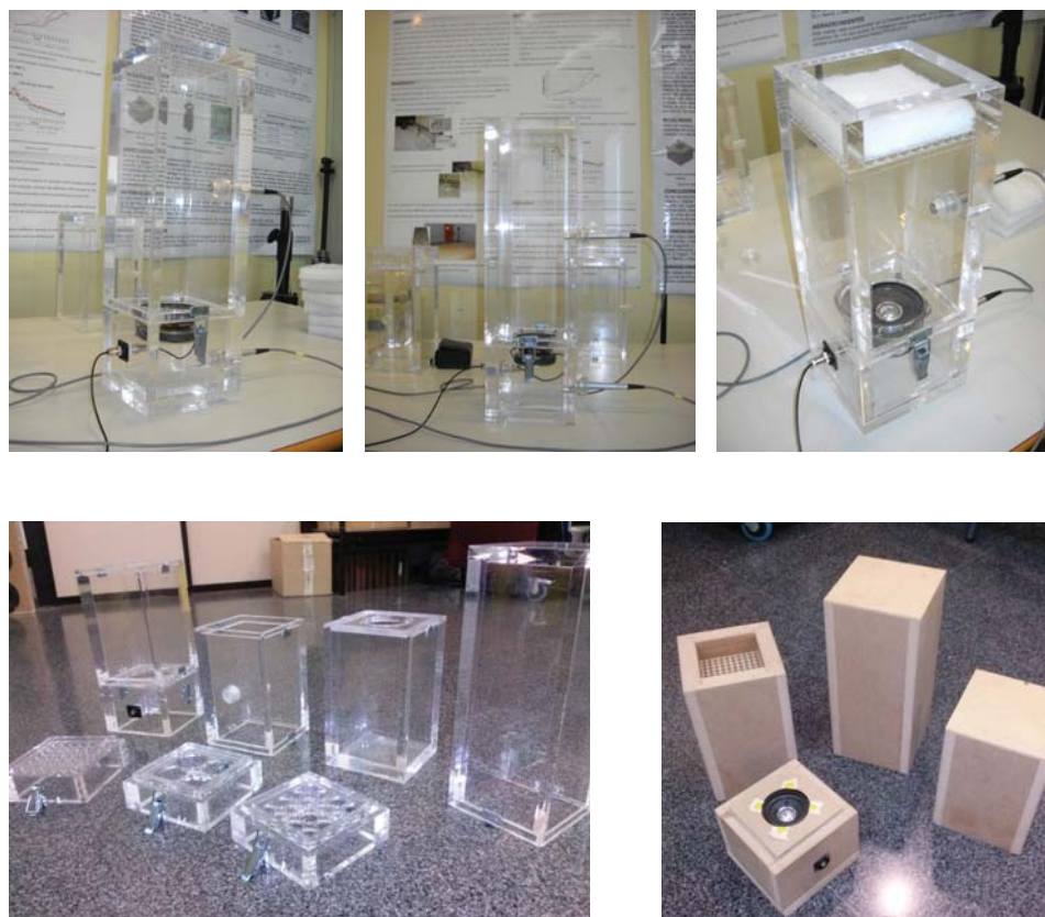
Figura 6.2. Prototipos para la medida de resistencia al flujo de materiales por técnicas alternativas.
