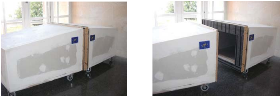
Figura 3.1. Cámara de transmisión de tamaño reducido construida. Estado inicial.
