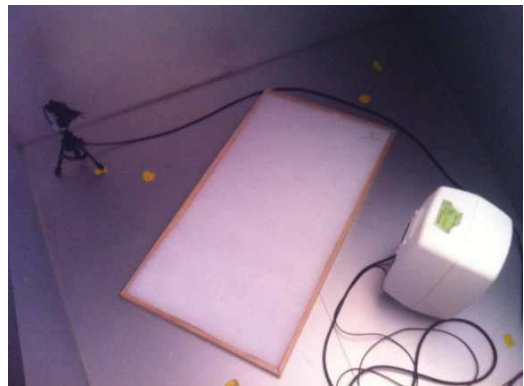
Figura 4.8. Interior de la cámara reverberante de tamaño reducido durante los ensayos
