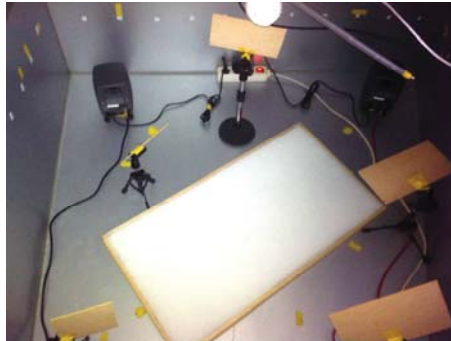
Figura 4.15. Interior de la cámara reverberante de tamaño reducido durante un ensayo, tras la aplicación de mejoras propuestas.
