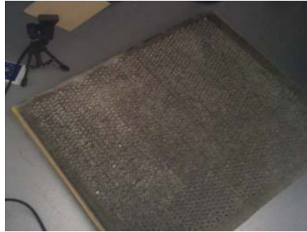
Figura 4. 16. Detalle de composite textil perforado con plenum de aire de 40mm, listo para el test de coeficiente de absorción sonora.
