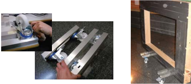
Figura 3.4. Preparación del sistema de ruedas que soportará el porta-muestras y porta-muestras independizado del recinto receptor
