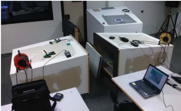
Figura 3.18. Captura de imagen durante la puesta en marcha de un ensayo de aislamiento acústico a ruido aéreo en cámara de transmisión de tamaño reducido.
