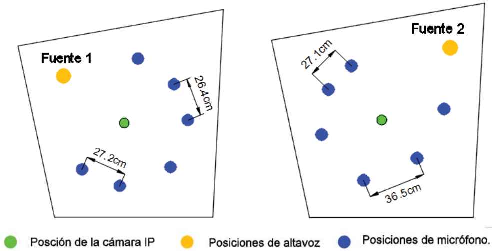
Figura 4.13. Posiciones de micrófono fijas para la realización de los ensayos tras la incorporación en el interior de la cámara de un sistema automatizado de movimiento de micrófono.
