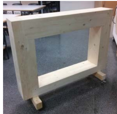
Figura 6.1. Nuevo portamuestras para la cámara de transmisión de tamaño reducido
