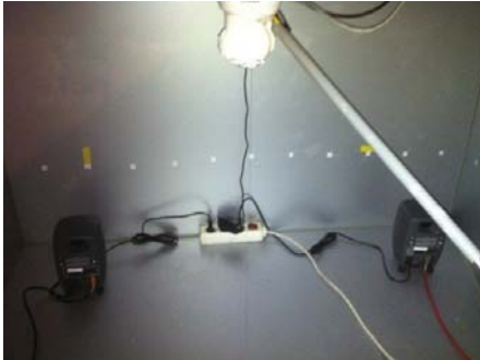
Figura 4.11. Interior de la cámara reverberante con sistema automatizado y emisores fijos instalados.
