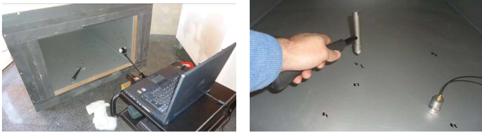
Figura 3.16. Medida del tiempo de reverberación estructural de los elementos del recinto receptor de la cámara de transmisión de tamaño reducido
