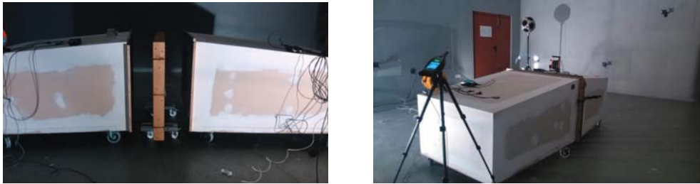
Figura 3.22. Imágenes tomadas durante las mediciones de aislamiento acústico de los cerramientos que conforman emisor y receptor de la cámara de transmisión de tamaño reducido.
