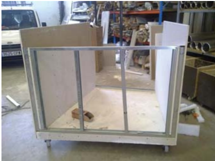
Figura 4.3. Solución constructiva de paredes, suelo y techo de la cámara reverberante de tamaño reducido.
