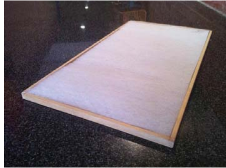
Figura 4.9. A la izquierda ejemplo de las tres muestras de uno de los materiales a ensayo y su correspondiente perímetro y a la derecha muestra y perímetro preparada para ensayar.
