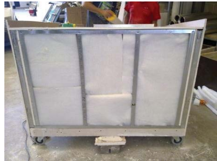
Figura 4.3. Solución constructiva de paredes, suelo y techo de la cámara reverberante de tamaño reducido.
