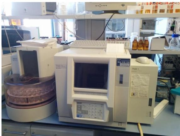
Figura 14: Equipo de determinación del carbono orgánico total (COT)
