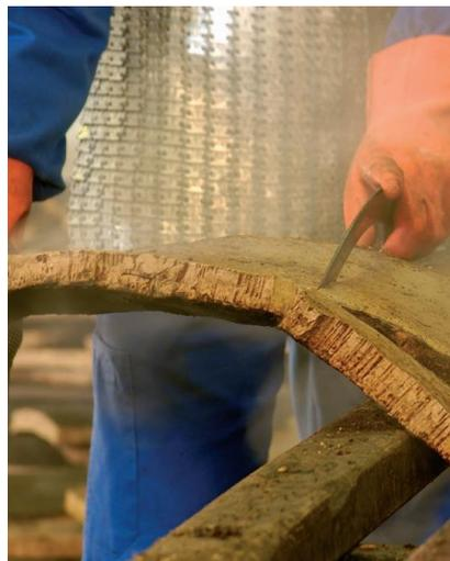
Figura 3: Separación de las planchas de corcho
