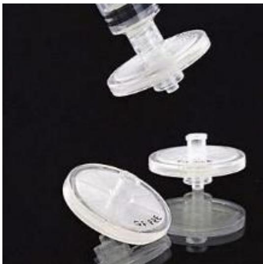
Figura 9: Filtros milipore de 0.45 $\mu\text{m}$
