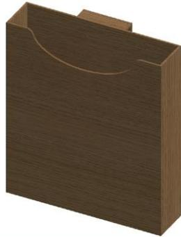
**Nota:** El espesor del tablero de bambú utilizado en la canasta portalibros es de 3mm, debido a que será utilizado para contener únicamente hojas y libros, por tal motivo no es necesario emplear un tablero de bambú de mayor resistencia, a diferencia de los utilizados en el tablero de la mesa y respaldo y asiento de la silla que son de 10mm.
