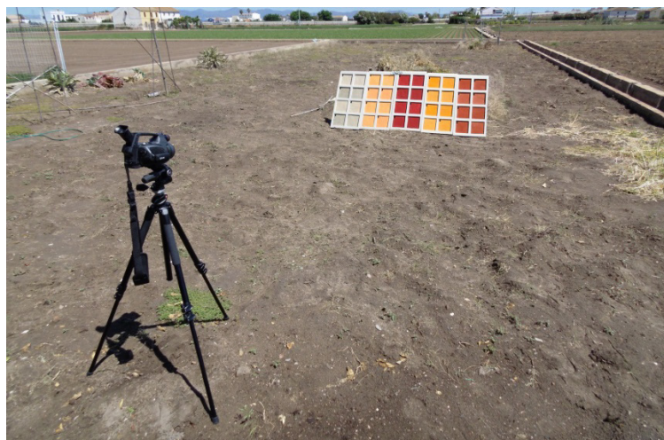
Figura 102: Cámara termográfica tomando datos
