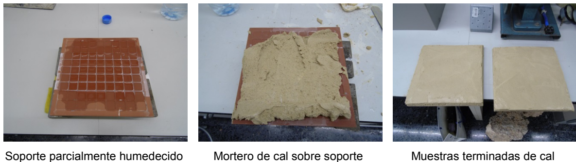
Figura 88: proceso de elaboración de una probeta
