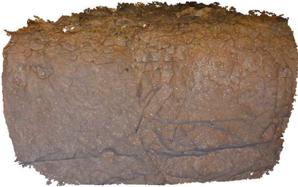
Figura 8. Vista en perspectiva de una nube de puntos a color obtenida a partir de un par de imágenes
