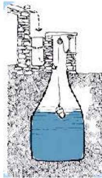
Imagen 1.9 Detalle depósito (filtro, cisterna, tapa, polea y cubo)
