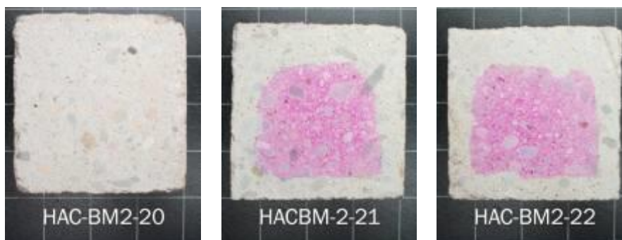
Figura 31: probetas resultado del ensayo de carbonatación (UNE13295)
