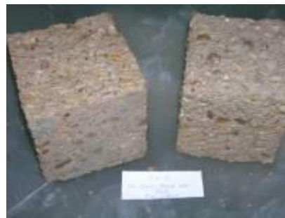
Figura 30: probetas del ensayo de hielo-deshielo (UNE CEN TS 12390-9)
