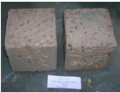
Figura 30: probetas del ensayo de hielo-deshielo (UNE CEN TS 12390-9)
