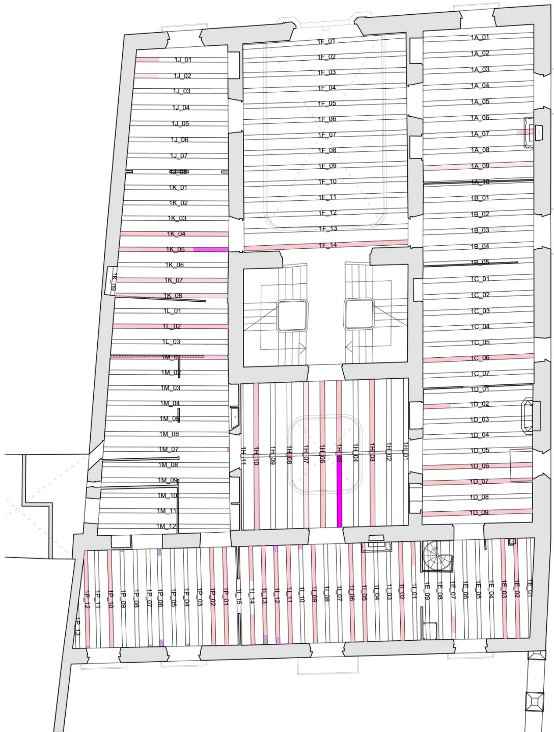
PROFUNDIDAD Y DISTRIBUCIÓN DE LA DEGRADACIÓN SUPERFICIAL
