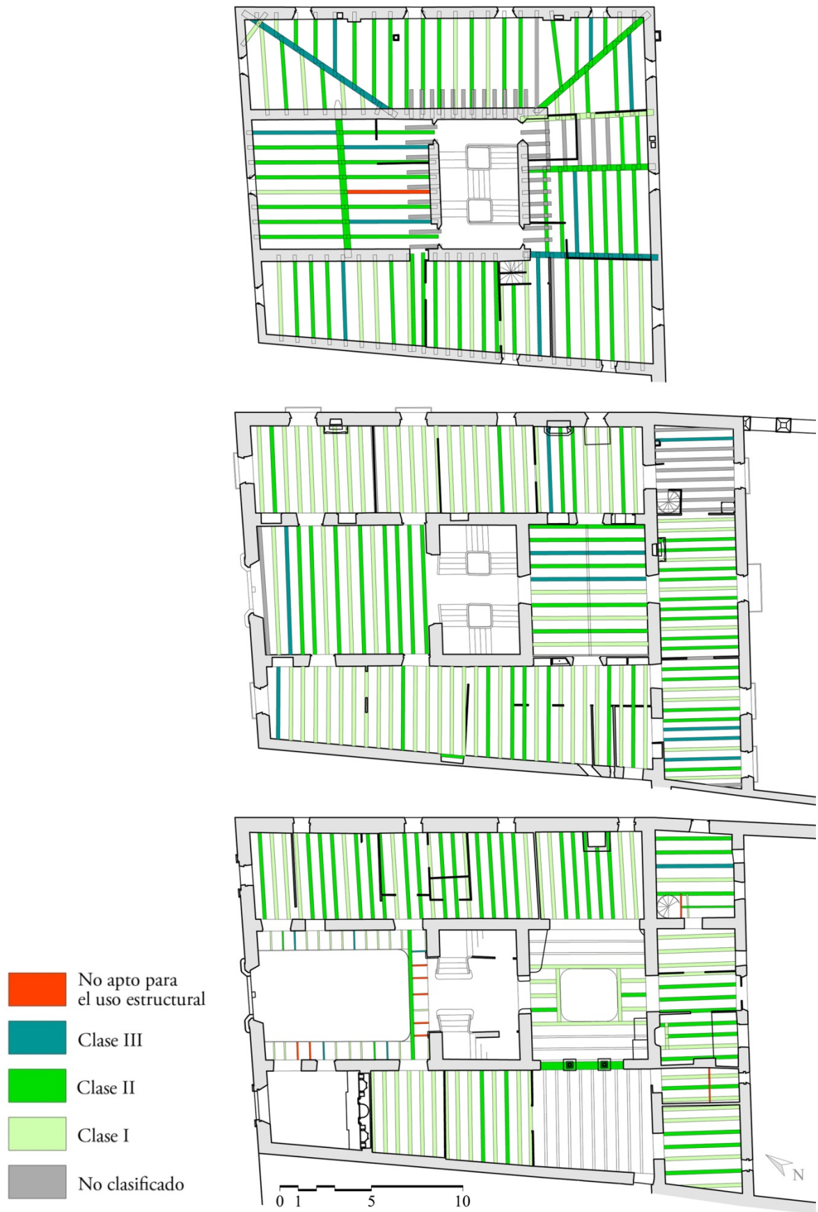
Figura 7.2. Planos de resumen de la clasificación de la estructura de madera del Palacio del Marqués de Benicarló según la norma italiana UNI 11119:2004.
