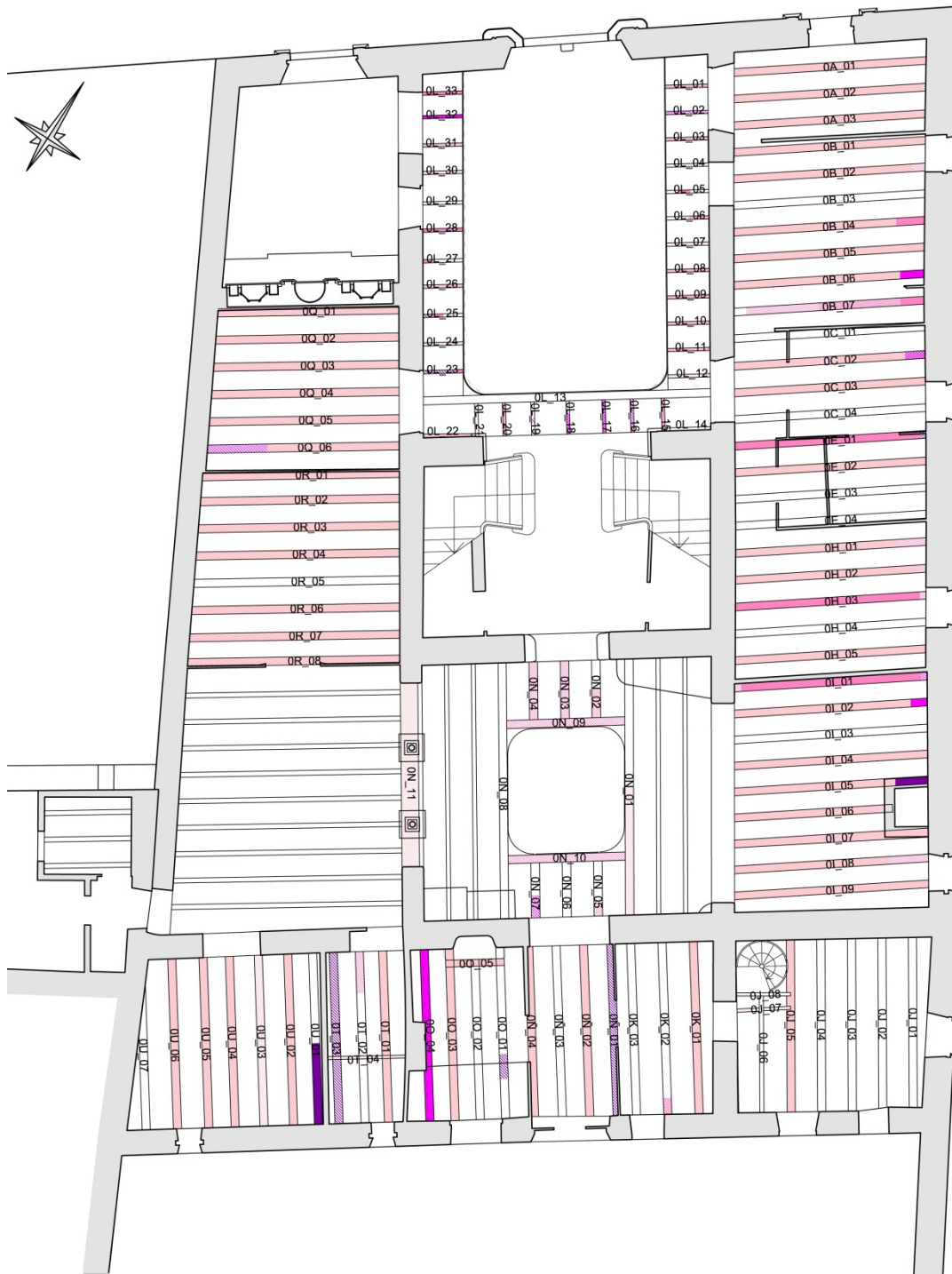
PROFUNDIDAD Y DISTRIBUCIÓN DE LA DEGRADACIÓN SUPERFICIAL
