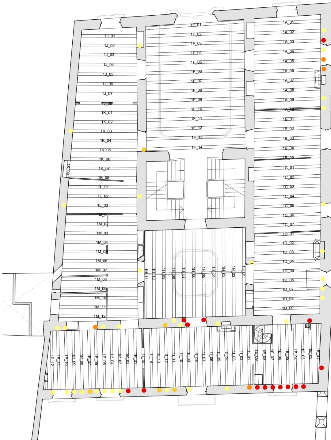
EXTENSIÓN DE LA DEGRADACIÓN EN LOS APOYOS PORCENTAJE DE SECCIÓN PODRIDA
