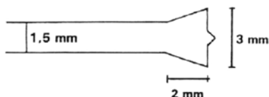
Figura 7.25. Dimensiones de la punta de los taladros resistográficos. La profundidad de penetración máxima normal es de 40 cm.
