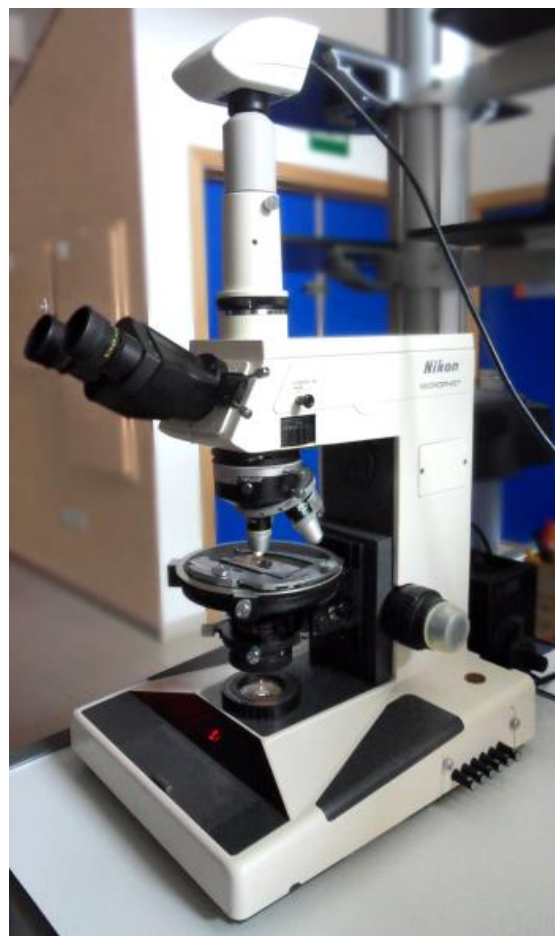
Figura 6.6. Microscopio óptico de transmisión Nikon H600L con cámara Leica DFC 426 y software de análisis de imagen LAS (Leica Acquisition Suite) del Servicio de Microscopía Electrónica de la Universitat Politècnica de València.
