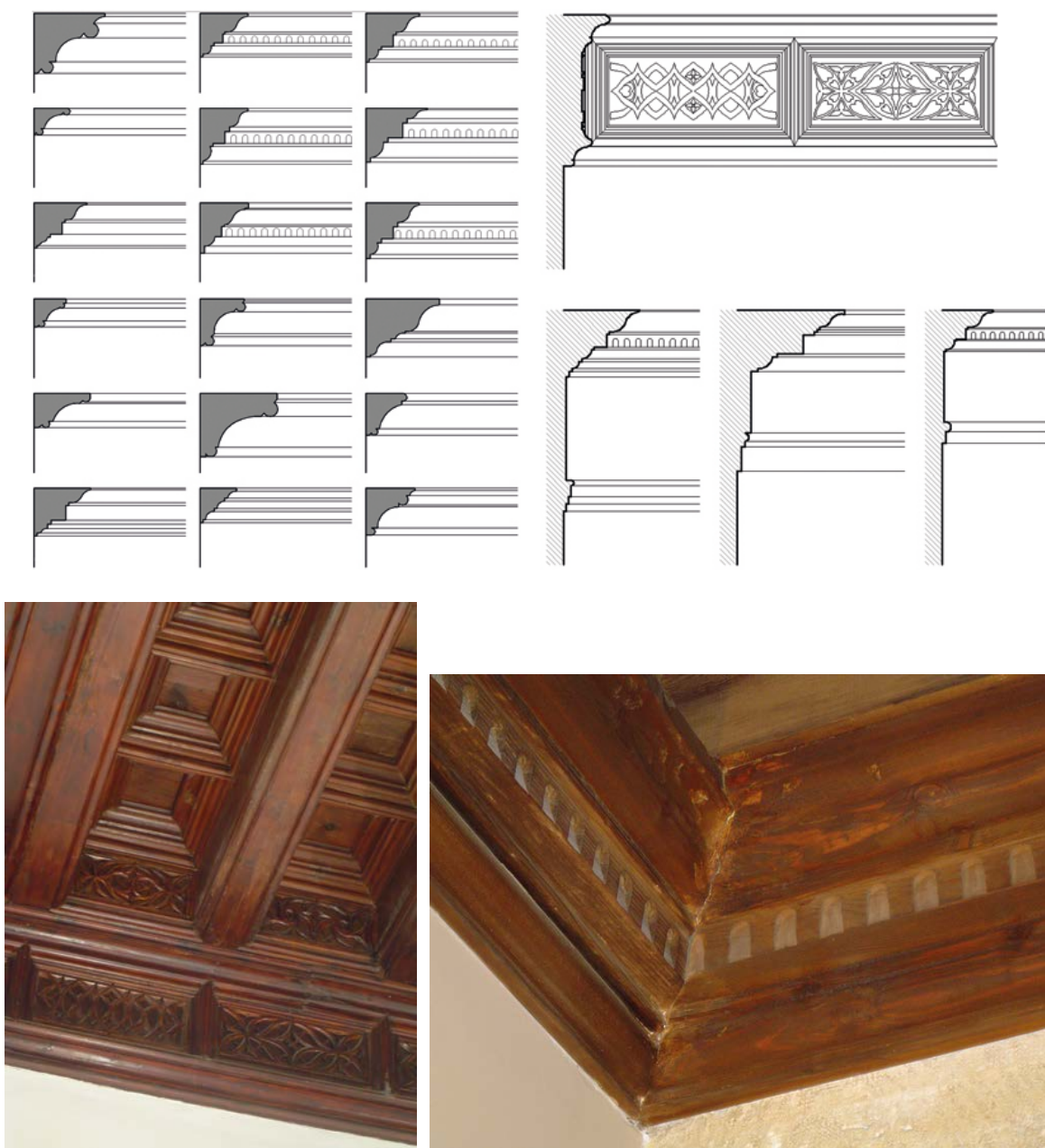
Figura 4.15. Ejemplos de cornisas. comunes, de gran altura, con pequeños arcos.
