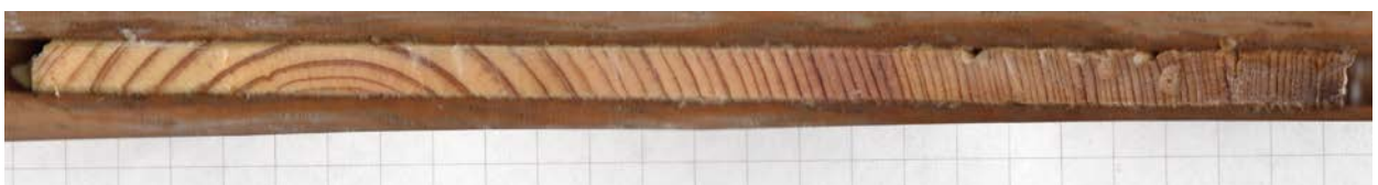
Figura 9.5. Ejemplos de muestras cilíndricas enrasadas y escaneadas a 2400dpi para su posterior medición. En la imagen de detalle se puede ver claramente la densidad y variabilidad de los anillos de crecimiento.
