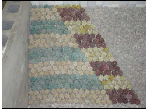
Figura 4.17. Primera capa de Cubípodos dispuestos a mano para apoyo en el CBPS. (Fuente: propia)
