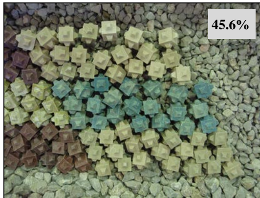
Figura A3.8. Resultado ensayo Malla 7 obtención máxima porosidad Cubípodos. (Fuente: propia)
