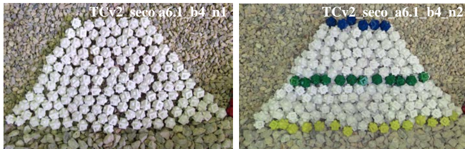
Figura 5.8. Manto construido con la malla de colocación estática para tronco curvo a/D_n = 1.605 y b/D_n = 1.053 del dique de San Andrés. Primera capa (izq.) y segunda capa (dcha.). (Fuente: propia)
