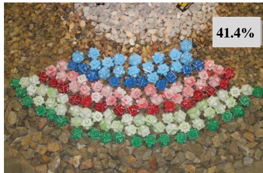
Figura A3.76. Resultado ensayo MR70_1.5_1510_6.4_b3.87_n1. (Fuente: propia)
