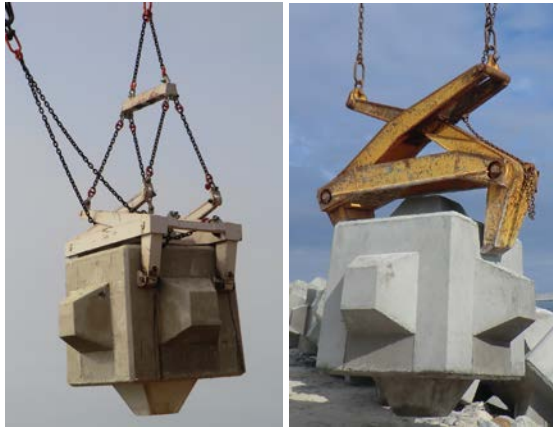
Figura 3.3. Pinzas de colocación del Cubípodo. Pinza doble (izq.) y simple (dcha). (Fuente: empresa SATO)
