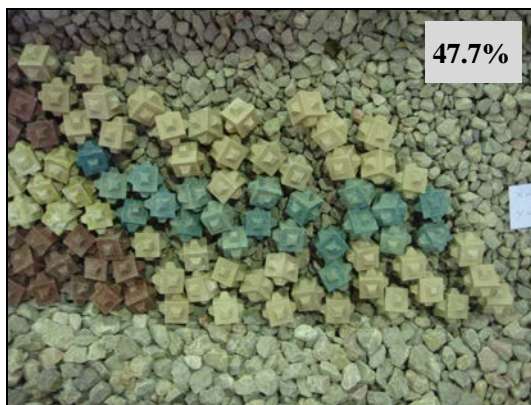
Figura A3.12. Resultado ensayo Malla 11 obtención máxima porosidad Cubípodos. (Fuente: propia)
