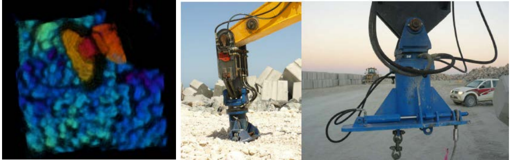
Figura 2.42. Sistema Echoscope y sistema de control de rotación para colocación de elementos de protección bajo el agua. (Fuente: Gelderen y Auld, 2009)
