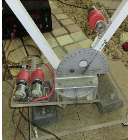
Figura 4.20. Transportadores de ángulos colocados en una de las grúas a escala empleada durante los ensayos. (Fuente: propia)
