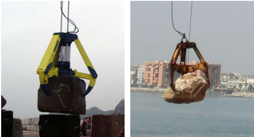
Figura 2.50. Pulpos para recuperación y colocación de elementos de protección. (Fuente: empresa SATO)
