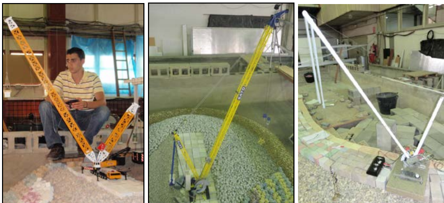
Figura 4.18. Grúas radiales a escala empleadas en los ensayos de construcción realista de mantos. (Fuente: propia)
