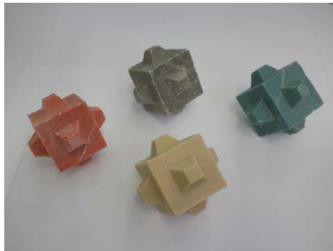
Figura 4.6. Cubípodos de D_n= 3.82 cm utilizados en los ensayos de colocación de Pardo (2009).
