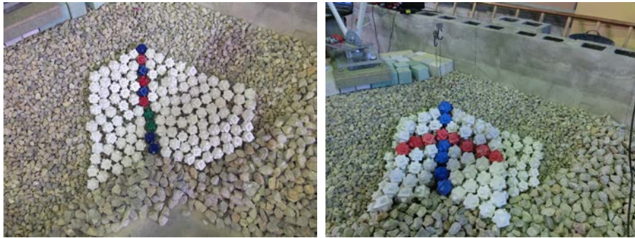
Figura 5.18. Mantos ensayados en el entronque del dique de San Andrés. Primera capa de 6 t (izq.) y segunda capa de 15 t (dcha.). (Fuente: propia)
