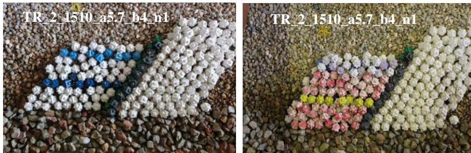
Figura 5.7. Manto construido con la malla de colocación estática para tronco recto a/D_n = 1.500 y b/D_n = 1.053 del Proyecto MMONOCAPA. Primera capa (izq.) y segunda capa (dcha.). (Fuente: propia)
