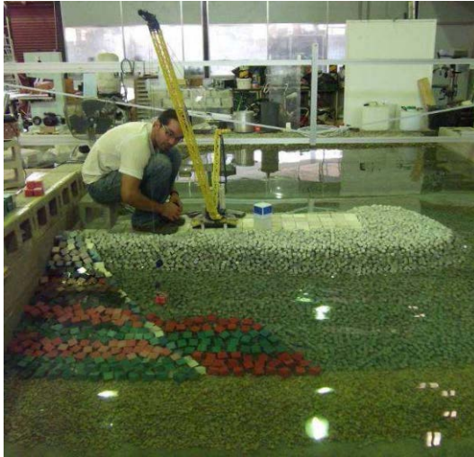
Figura 2.9. Ensayo de colocación realista 3D de cubos de Pardo et al. (2012).
