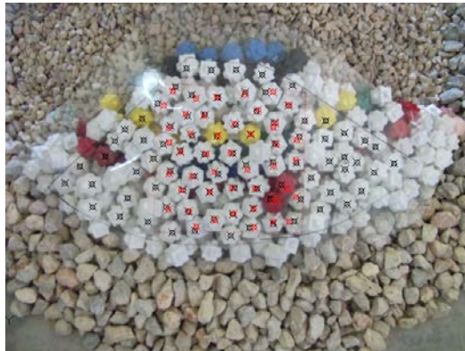
Figura 4.22. Áreas de referencia empleada para el cálculo de la porosidad en morros. (Fuente: propia)
