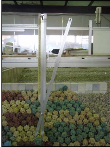
Figura 4.14. Pinza empleada en el CBPS. (Fuente: propia)
