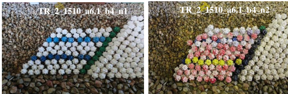
Figura 5.6. Manto construido con la malla de colocación estática para tronco recto a/D_n = 1.605 y b/D_n = 1.053 del Proyecto MMONOCAPA. Primera capa (izq.) y segunda capa (dcha.). (Fuente: propia)
