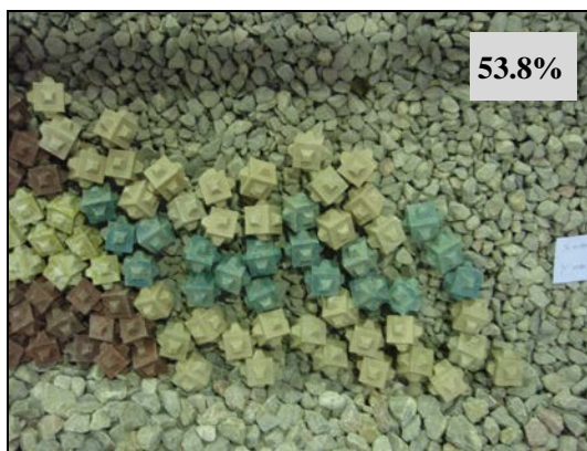
Figura A3.13. Resultado ensayo Malla 12 obtención máxima porosidad Cubípodos. (Fuente: propia)
