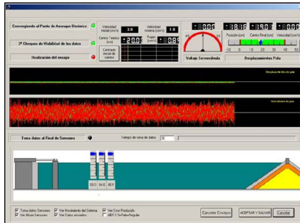
Figura 4.3. Vista del programa informático generador de oleaje. (Fuente: propia)
