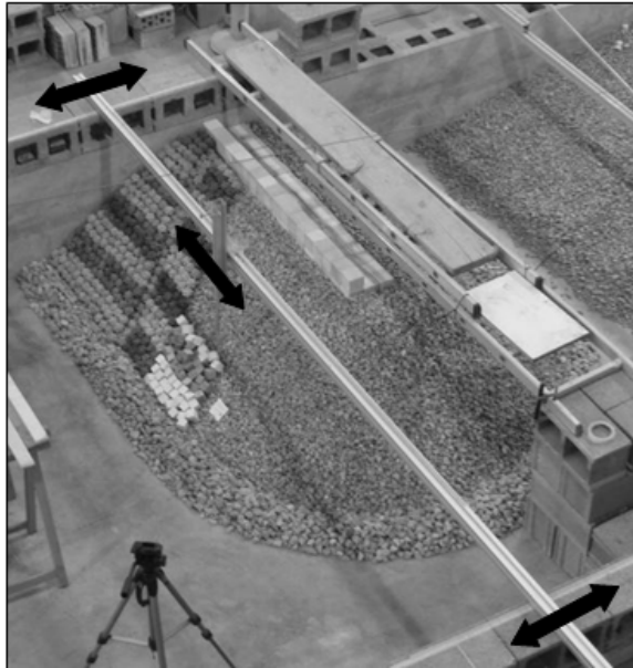
Figura 2.8. Sistema Cartesiano de Colocación Ciega empleado por Pardo et al. (2010).
