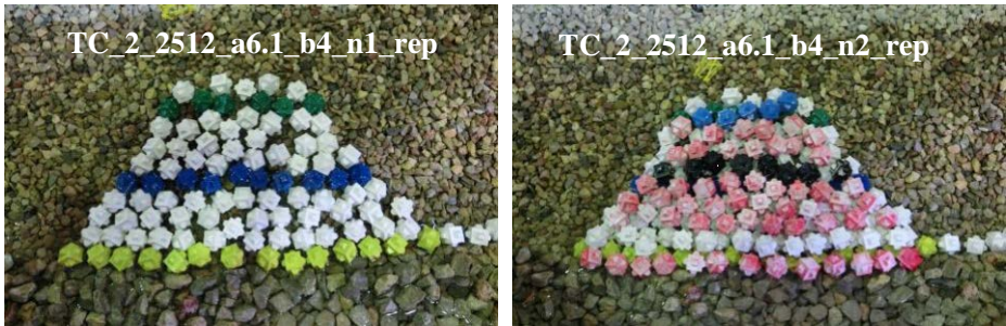
Figura 5.9. Manto construido con la malla de colocación estática para tronco curvo a/D_n = 1.605 y b/D_n = 1.053 del Proyecto MMONOCAPA sobre talud H/V=2/1 . Primera capa (izq.) y segunda capa (dcha.). (Fuente: propia)
