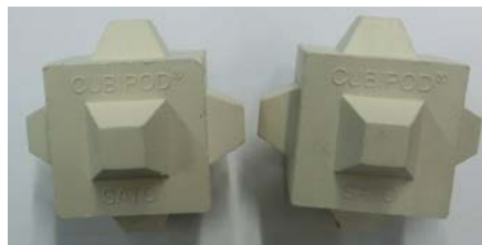
Figura 4.9. Cubípodos de D_n = 3.80 cm utilizados en los ensayos de colocación del dique de San Andrés del Puerto de Málaga. (Fuente: propia)
