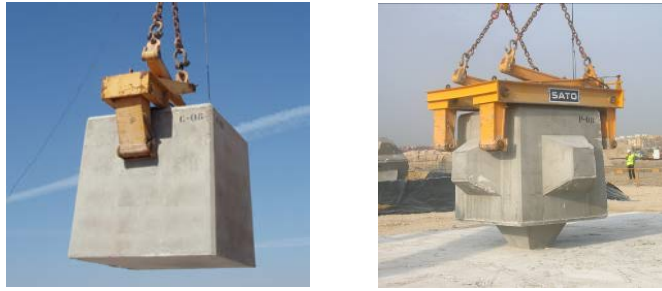
Figura 2.49. Pinzas de presión para manipulación de cubos y Cubípodos. (Fuente: empresa SATO)
