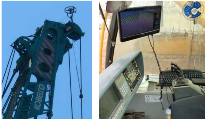
Figura 2.38. Tecnología en la colocación de piezas en el manto principal. GPS colocado en grúa (izq.) y programa informático de colocación en cabina operador (dcha.). (Fuente: propia)
