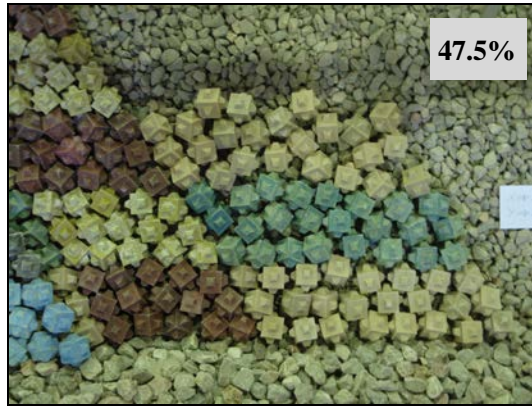
Figura A3.3. Resultado ensayo Malla 3 obtención mínima porosidad Cubípodos. (Fuente: propia)
