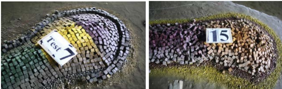
Figura 2.10. Ensayos de colocación llevados a cabo por Ali et al. (2014). Colocación regular (izq.) y colocación aleatoria (dcha.)
