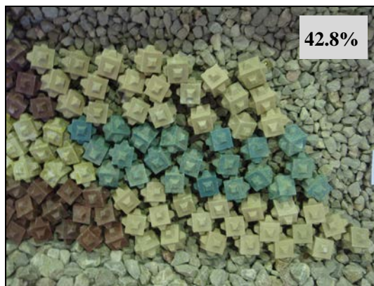
Figura A3.9. Resultado ensayo Malla 8 obtención máxima porosidad Cubípodos. (Fuente: propia)
