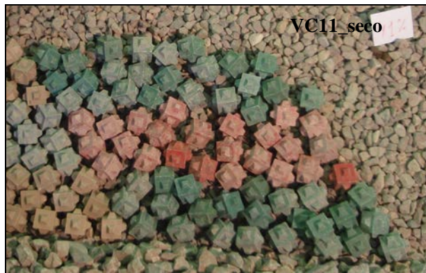
Figura 5.2. Manto construido con la malla de colocación estática para tronco recto a/D_n = 1.565 y b/D_n = 1.018 de Pardo (2009) en seco. (Fuente: propia)
